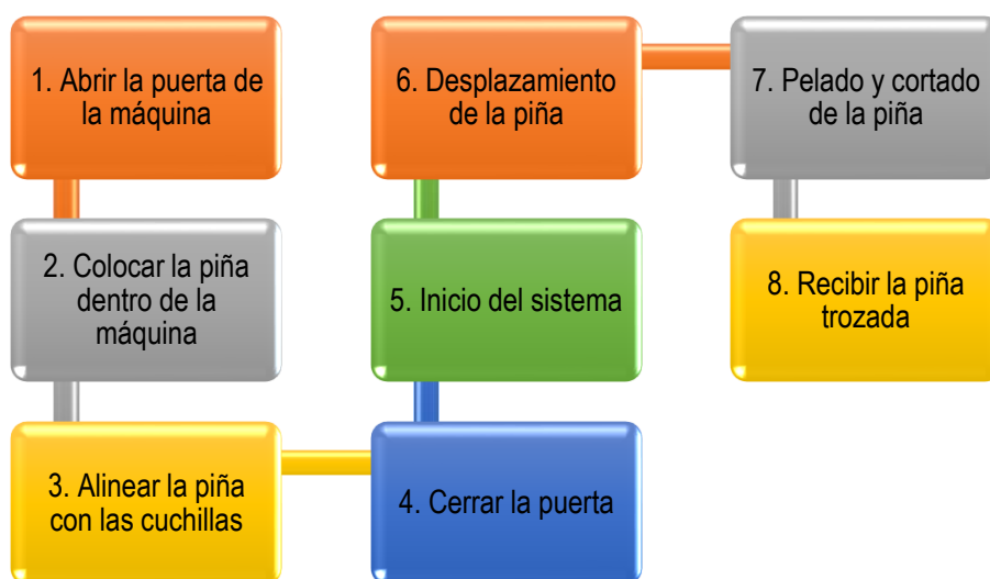
Ilustración 24: Secuencia de operaciones de la peladora y picadora de piñas
