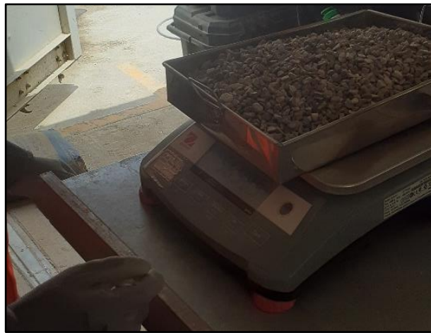
Pesado del agregado grueso para ensayos de propiedades físicas
