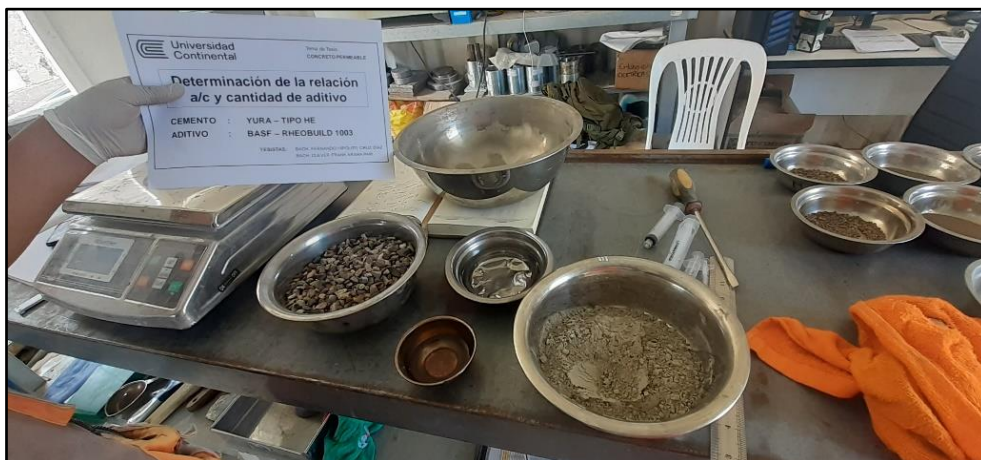
Pruebas con pasta de cemento y agregado para evaluar la estabilidad de la pasta de cemento
