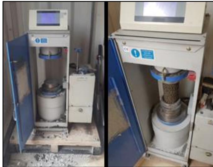
Prensa y ensayo de resistencia a la compresión de cilindros de concreto permeable
