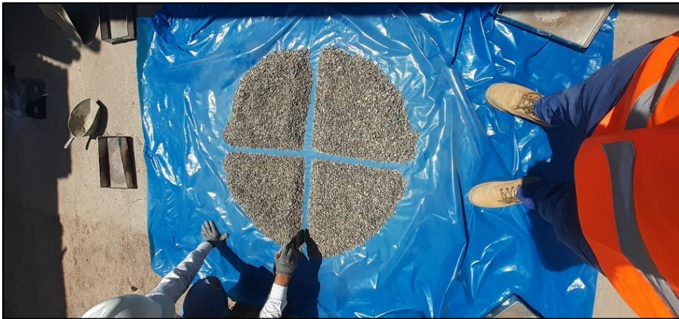
Cuarqueo del agregado grueso para los ensayos de propiedades físicas
