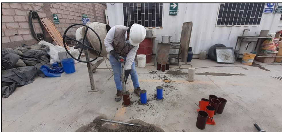
Pruebas para determinar el número de golpes necesarios para la elaboración de cilindros de concreto permeable
