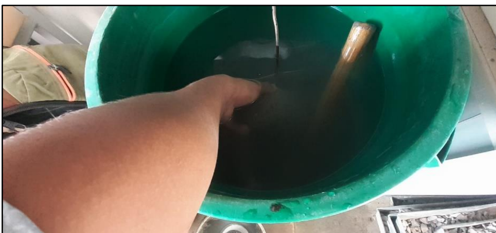
Colocacion de cilindros en el contenedor con agua para su saturacion y ensayo de peso unitario y contenido de vacíos del concreto permeable endurecido
