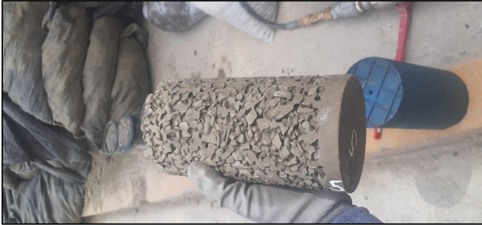
Probeta con pasta de cemento inadecuada, ya que fluyó a la parte inferior del concreto
