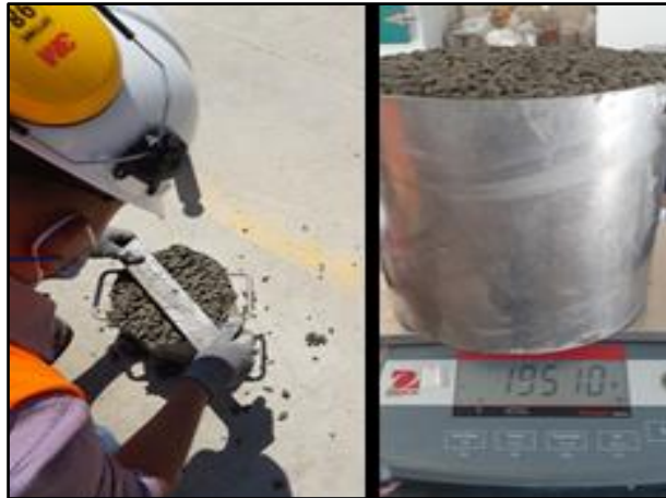
Ensayo de peso unitario y contenido de vacíos del concreto permeable fresco
