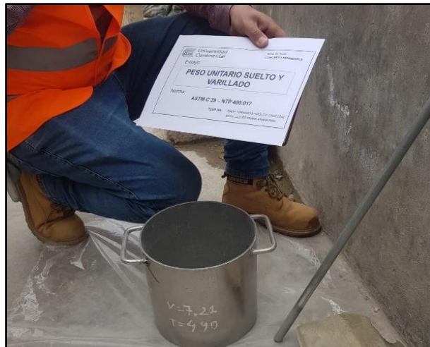
Molde para el ensayo de peso unitario del agregado grueso
