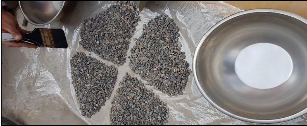
Cuarteo del agregado grueso para ensayos de propiedades físicas
