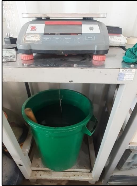
Pesado de un cilindro de concreto permeable en el agua para el ensayo de peso unitario y contenido de vacíos del concreto permeable endurecido
