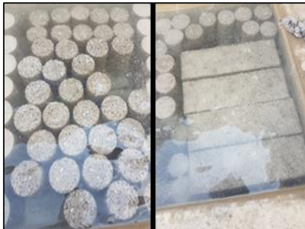
Colocación de cilindros y vigas de concreto permeable en la poza de curado
