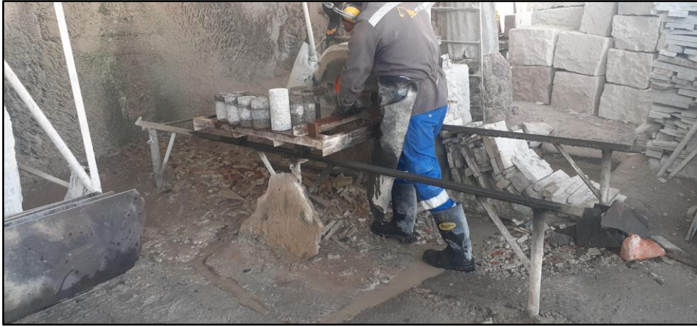
Cortado de cilindros para la prueba de permeabilidad
