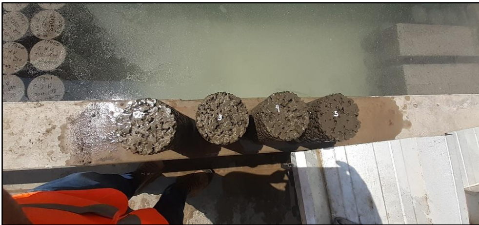
Elaboración de probetas con correcciones en la cantidad de aditivo para evaluar la estabilidad de la pasta de cemento
