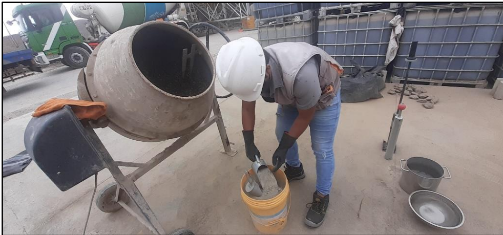
Preparación de las mezclas de concreto permeable
