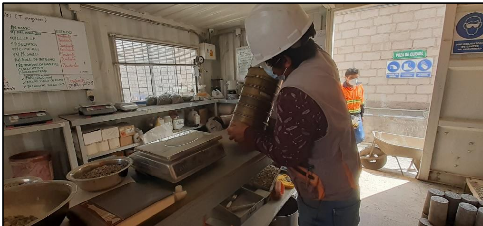
Ensayo de granulometría del agregado grueso
