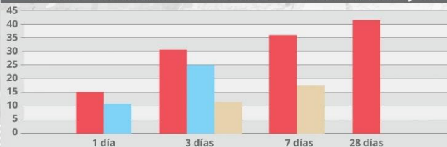
COMPARACIÓN RESISTENCIAS A LA COMPRESIÓN CEMENTO INDUSTRIAL YURA TIPO HE Vs. NTP CEMENTO TIPO I y HE
