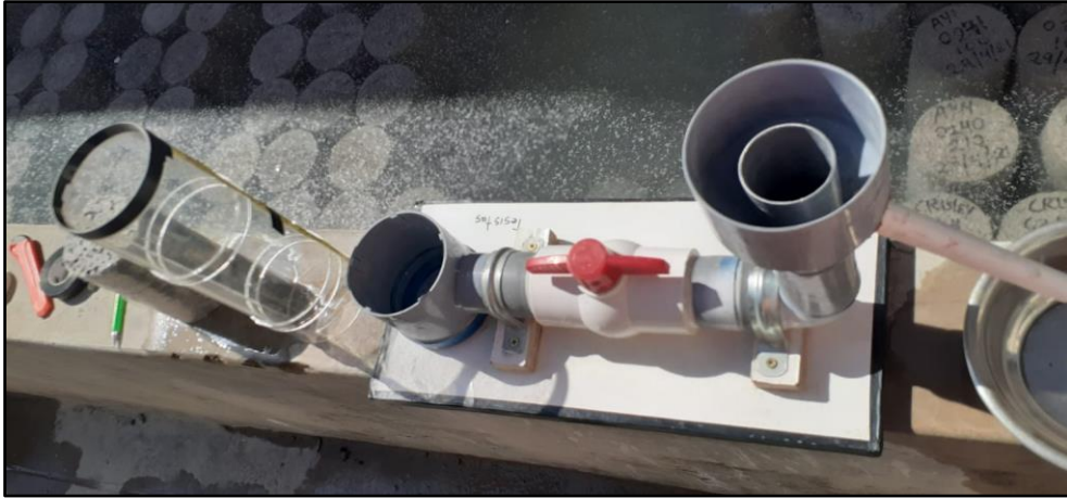
Permeámetro usado para la prueba de permeabilidad de los cilindros de concreto permeable
