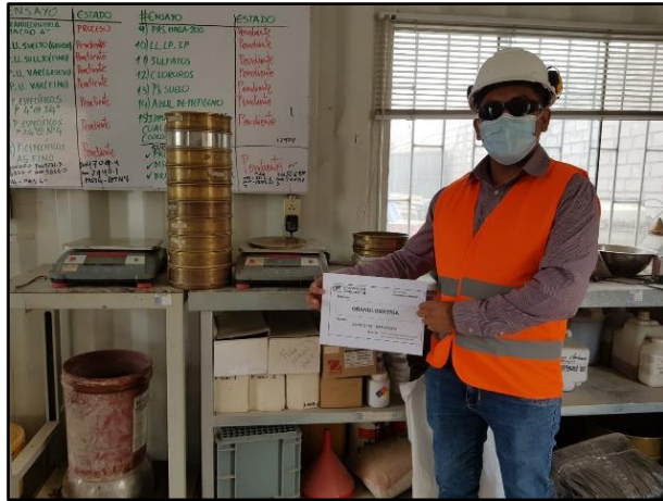
Preparación de los tamices para el ensayo de granulometría del agregado grueso
