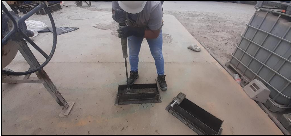
Pruebas para determinar el número de golpes necesarios para la elaboración de vigas de concreto permeable
