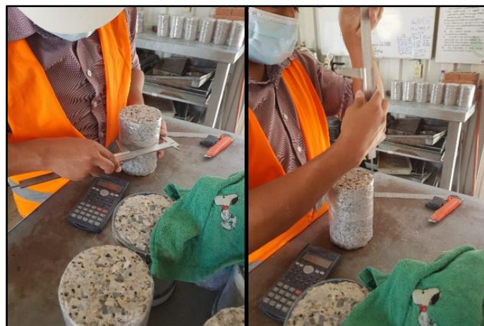
Toma de medidas de los cilindros para la prueba de permeabilidad
