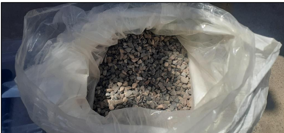
Agregado grueso colocado en sacos con bolsas de polietileno
