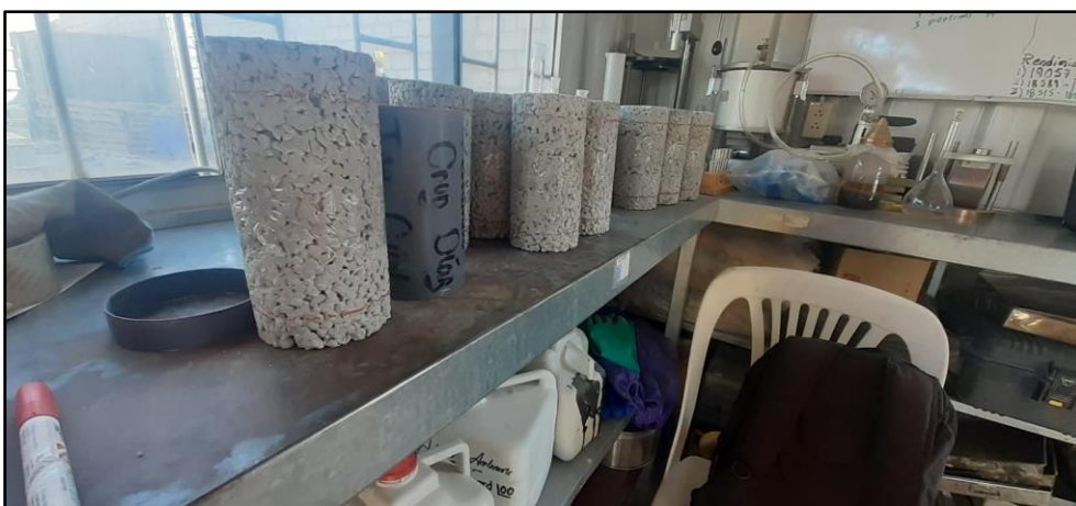
Cilindros marcados para que sean cortados antes de la prueba de permeabilidad
