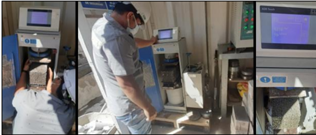
Ensayo de resistencia a la tracción por flexión de las vigas de concreto permeable
