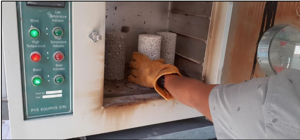
Cilindros de concreto permeable en el horno, para el ensayo de peso unitario y contenido de vacíos del concreto permeable endurecido
