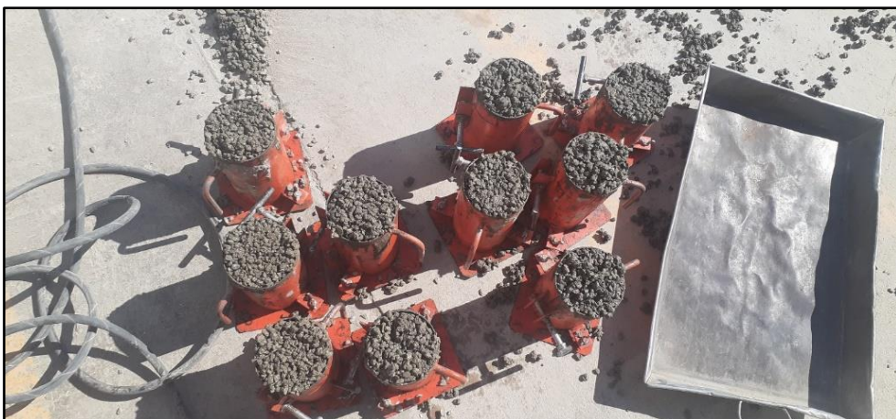
Elaboración de cilindros y vigas de concreto permeable
