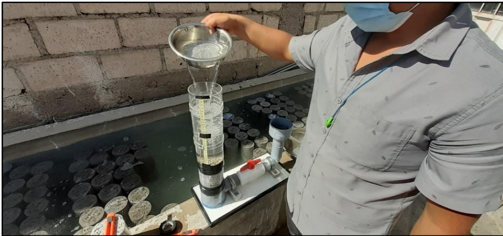
Prueba de permeabilidad de los cilindros de concreto permeable
