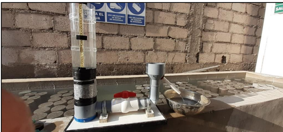
Prueba de permeabilidad cilindros de concreto permeable
