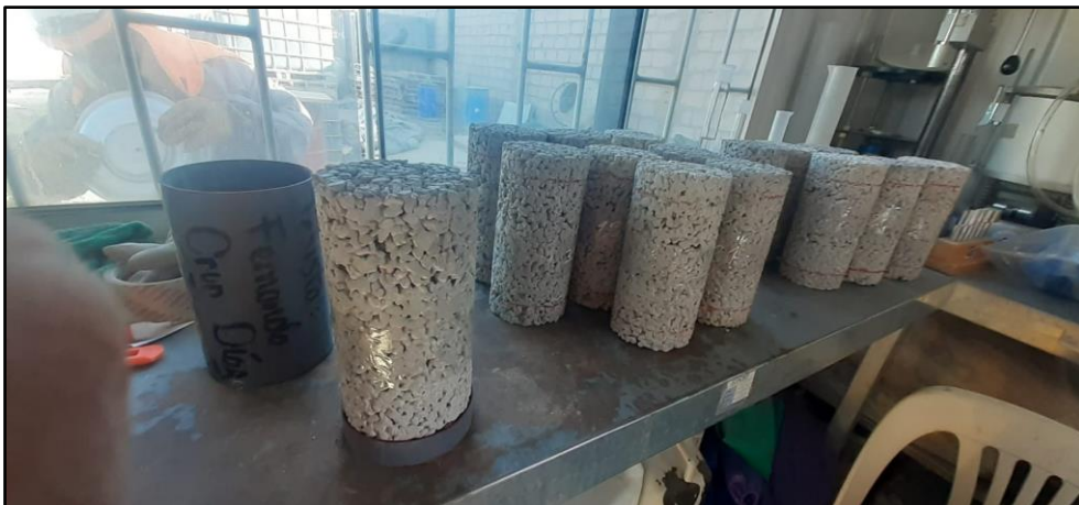
Marcado de cilindros antes de que sean cortados para la prueba de permeabilidad
