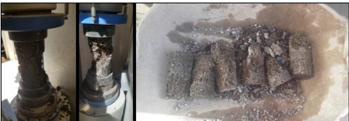
Cilindros de concreto permeable luego del ensayo de resistencia a la compresión
