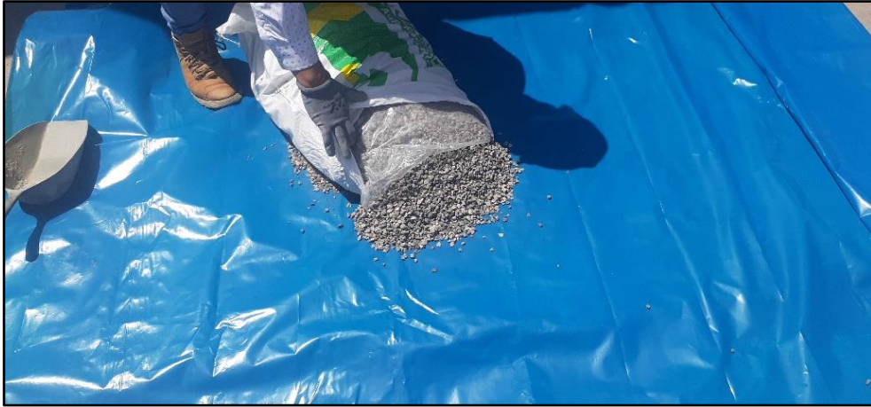
Esparcido del agregado grueso para realizar el cuarto para los ensayos de propiedades físicas
