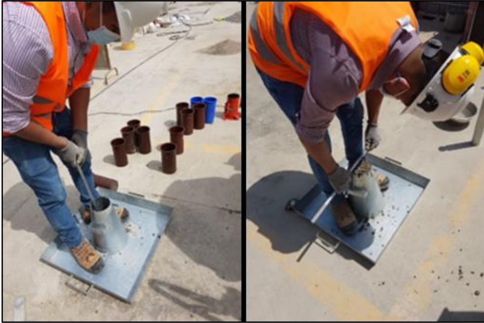
Ensayo de asentamiento – Slump al concreto permeable fresco
