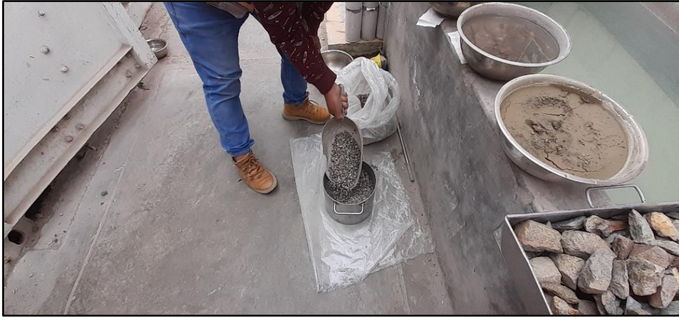
Ensayo de peso unitario suelto del agregado grueso
