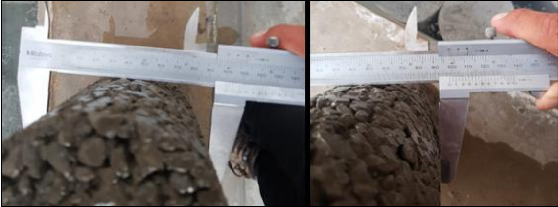
Medición de los diámetros de las probetas para el ensayo de resistencia a la compresión
