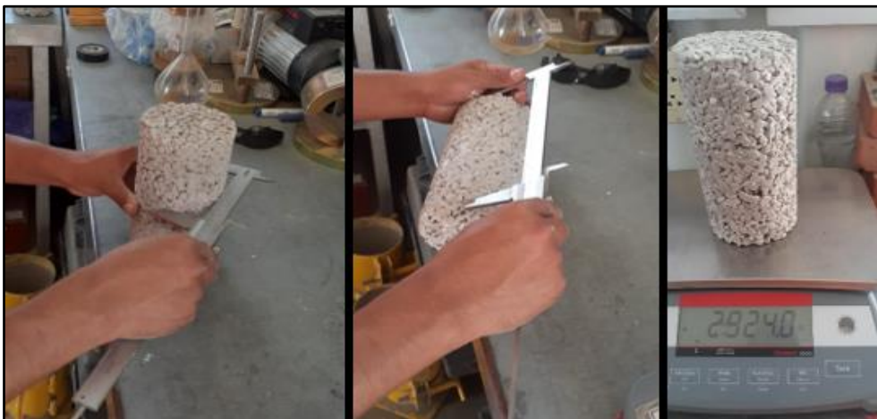
Toma de medidas y pesado de cilindros de concreto permeable para el ensayo de peso unitario y contenido de vacíos del concreto permeable endurecido
