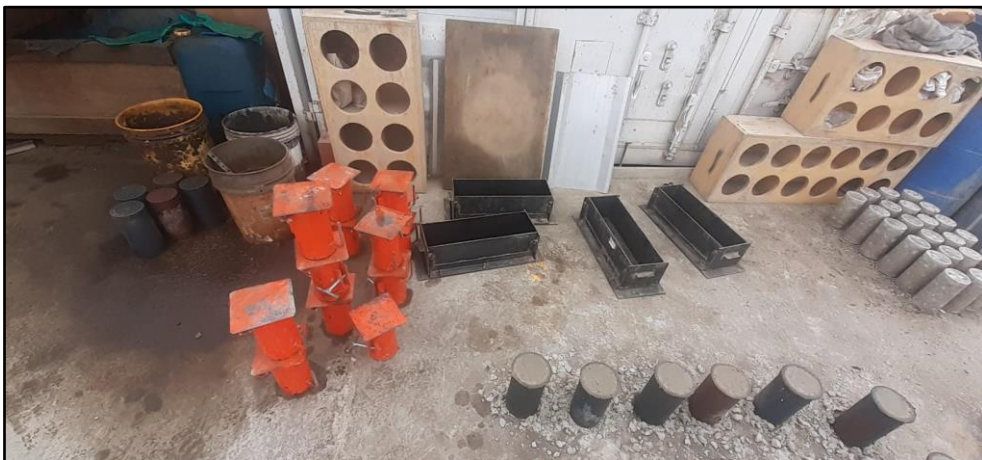
Preparación de los moldes para la elaboración de cilindros y vigas de concreto permeable
