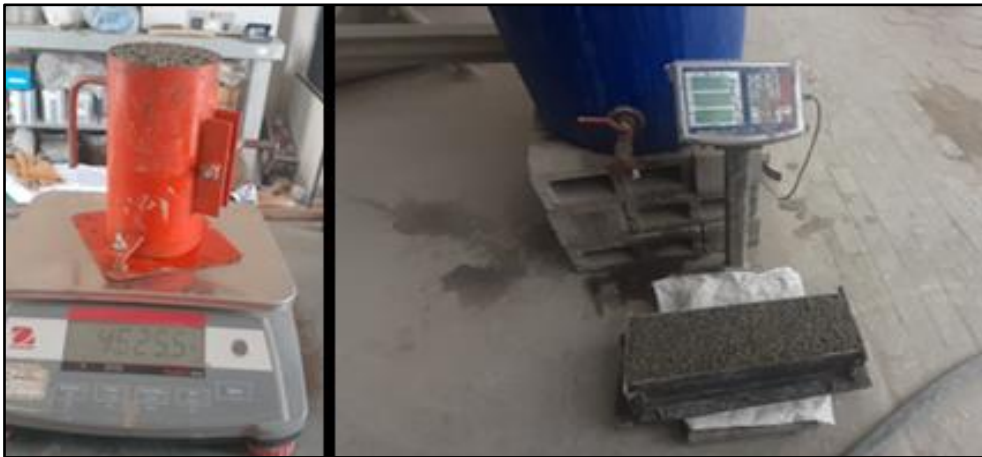
Pesado de moldes con concreto para determinar el número de golpes necesarios para la elaboración de cilindros y vigas de concreto permeable
