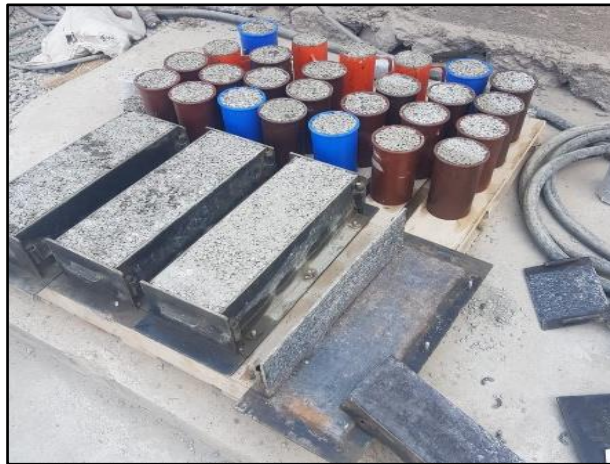
Desmoldado de cilindros y vigas de concreto permeable
