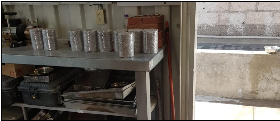
Preparación de cilindros para la prueba de permeabilidad
