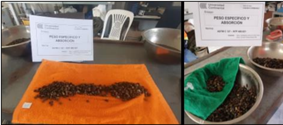
Secado superficial del agregado grueso para el ensayo de peso específico y absorción
