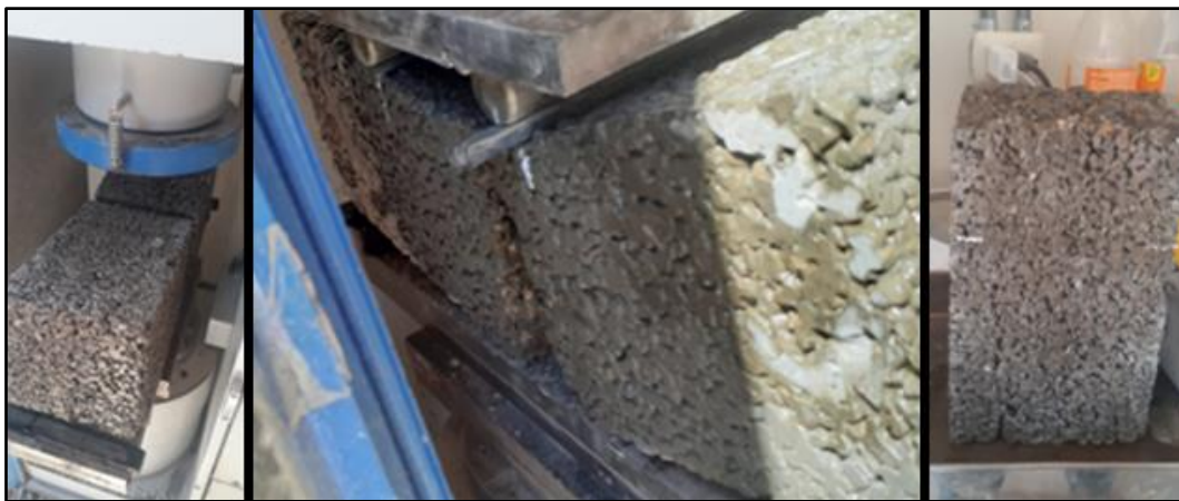
Viga de concreto permeable luego del ensayo de resistencia a la tracción por flexión
