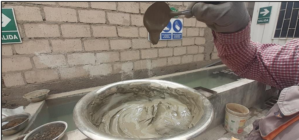
Pruebas con pasta de cemento para determinar la relación a/c y dosis de aditivo para los diseños de mezclas de concreto permeable
