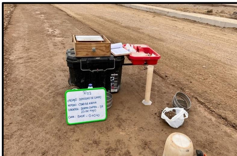
**Paso 4)** Se verifica y se controla la calidad de material granular a colocar en la base de ciclovía, manteniendo los requerimientos granulométricos según especificaciones técnicas del proyecto.
