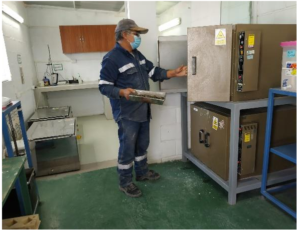
Secado de muestra malla 200
