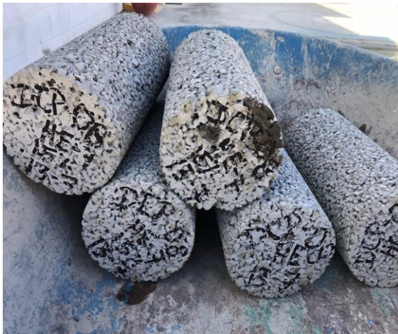
Probetas rotuladas, preparadas para ensayo a compresión
