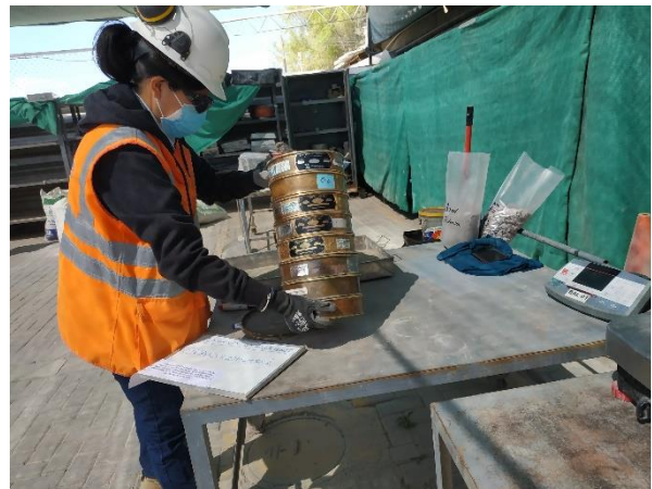
Ensayo de granulometrías
