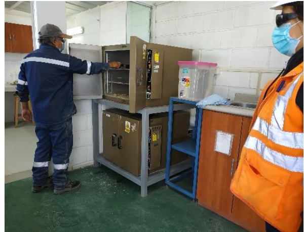
Secado de muestra malla 200
