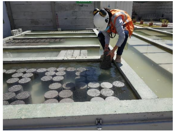
Colocación de especímenes en poza
