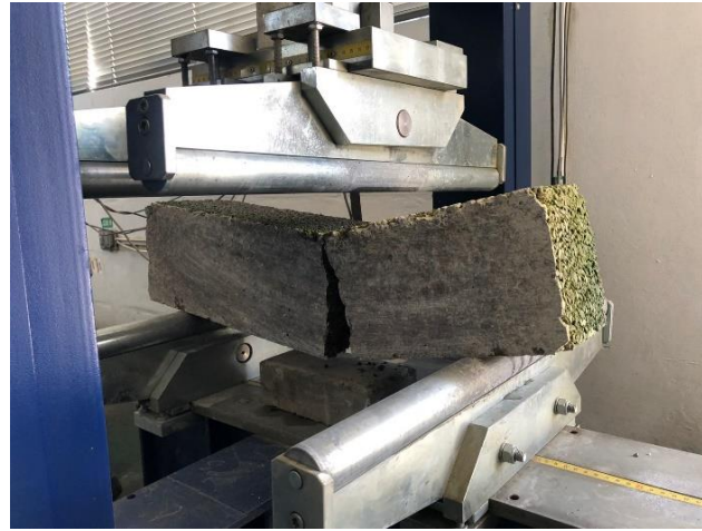
Rotura de vigas rectangulares ensayo resistencia a la flexion
