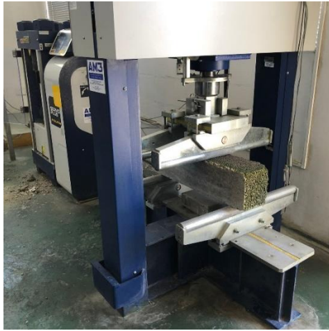
Rotura de vigas rectangulares ensayo resistencia a la flexion
