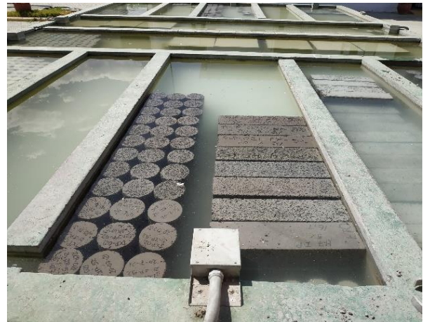
Curado final de las probetas y vigas
