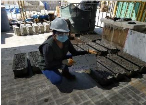
Desmolde de especímenes viga
