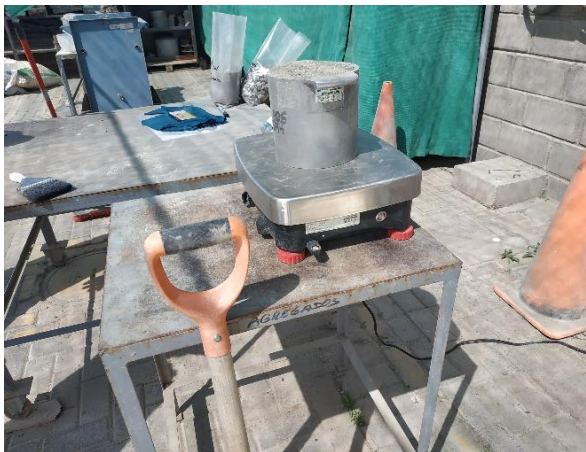
Peso unitario del agregado fino
