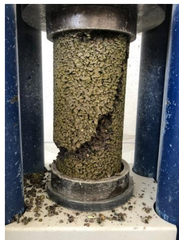
Testigo ensayado huso 89
