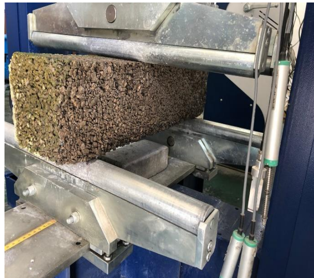
Ensayo de flexión a especímenes tipo viga
