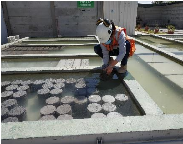
Curado final de las probetas y vigas
