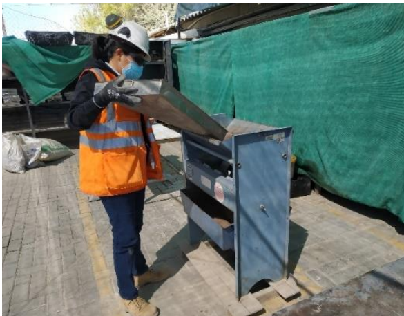
Cuarteo de los agregados
