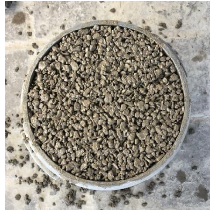
Concreto en olla para peso unitario
