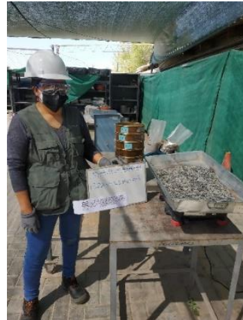
Granulometría del agregado grueso
