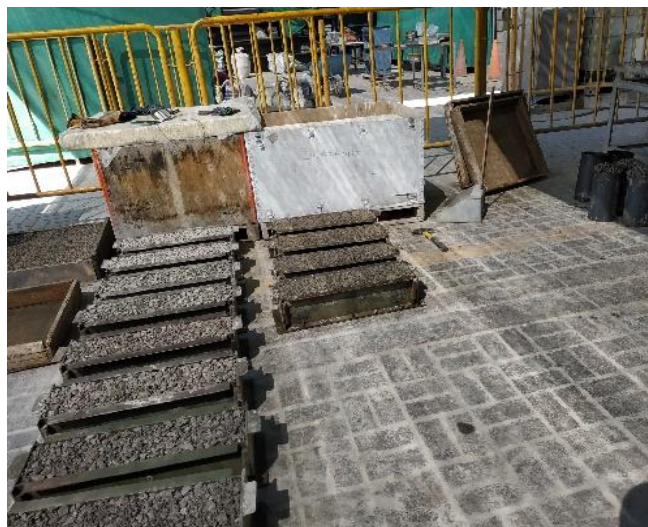
Probetas cilíndricas y vigas en cámara de curado inicial
