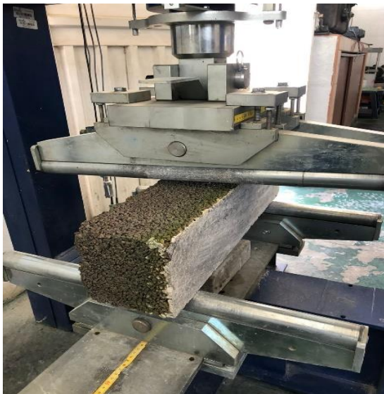
Ensayo de flexión a especímenes tipo viga
