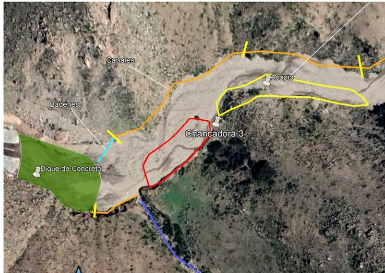
**Figura 32.** Descarga de aguas en Dique de Concreto Existente
