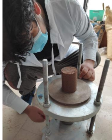
especimen tallado para laboratorio
