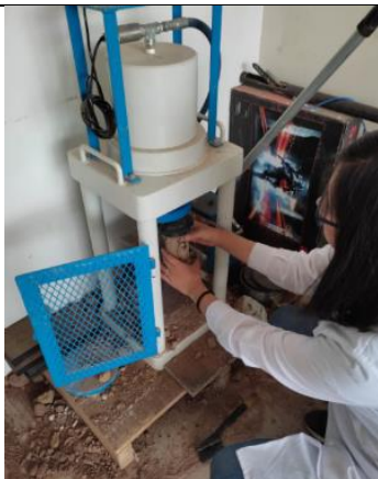
especimen en dispositivo de carga axial
