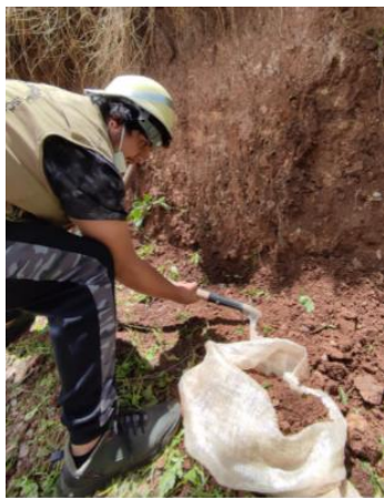
Extracción del suelo limoso
