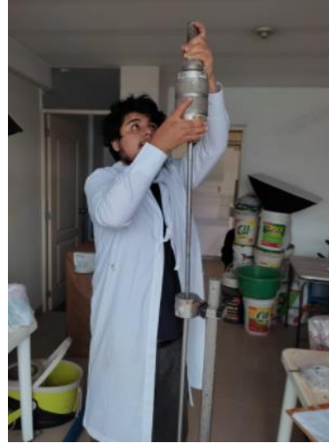
Prueba de penetración de cono dinámico
