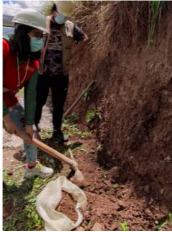
Extracción del suelo limoso
