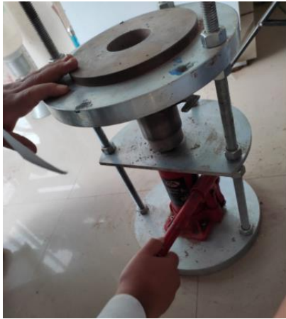
tallado del espécimen con la prensa
