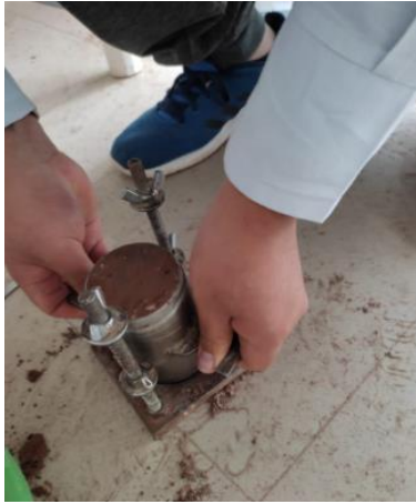
desarmado del molde
