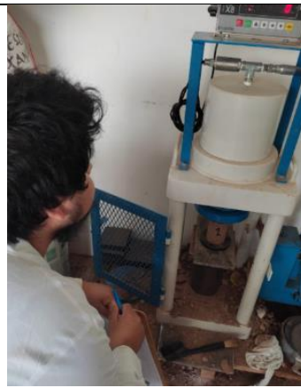
especimen en dispositivo de carga axial
