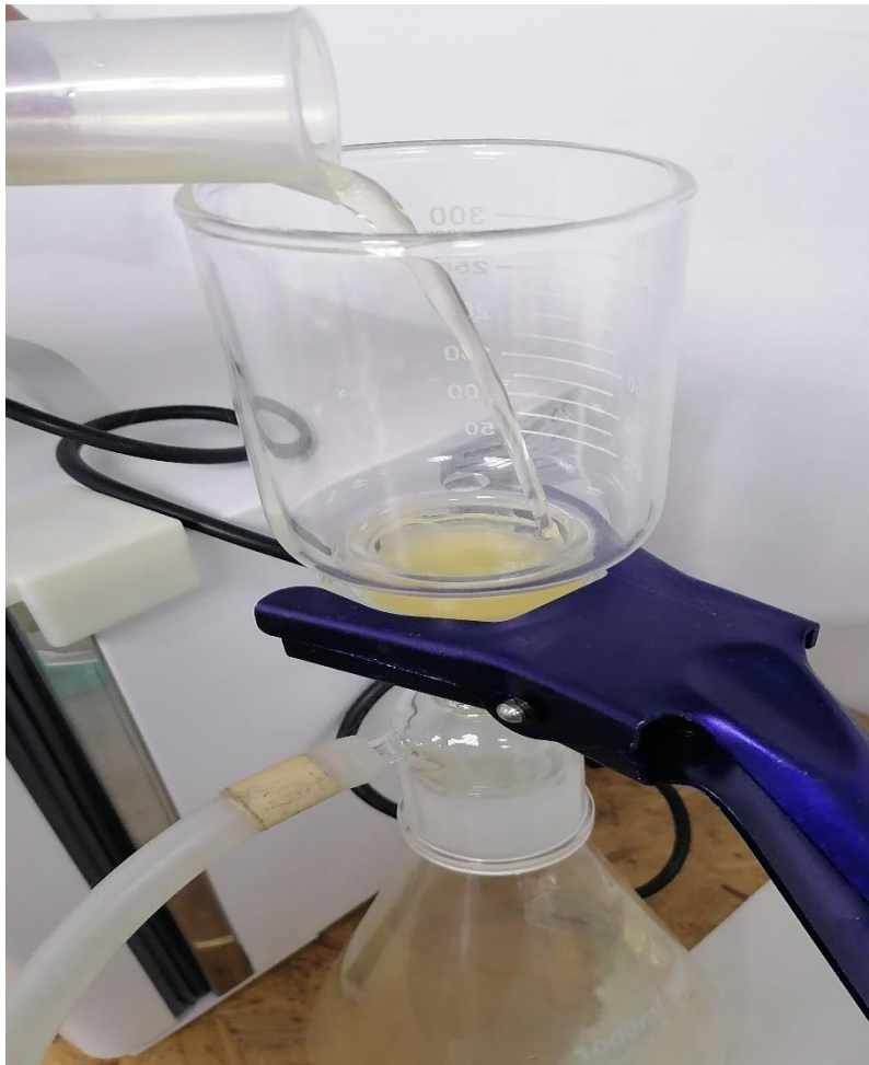
Figura 10: Filtración al vacío de muestras tomadas para determinación de DQO
