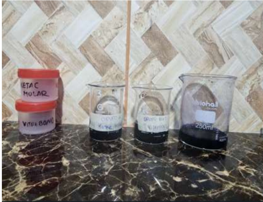
Tinción con azul de metileno al 1% por 24h
