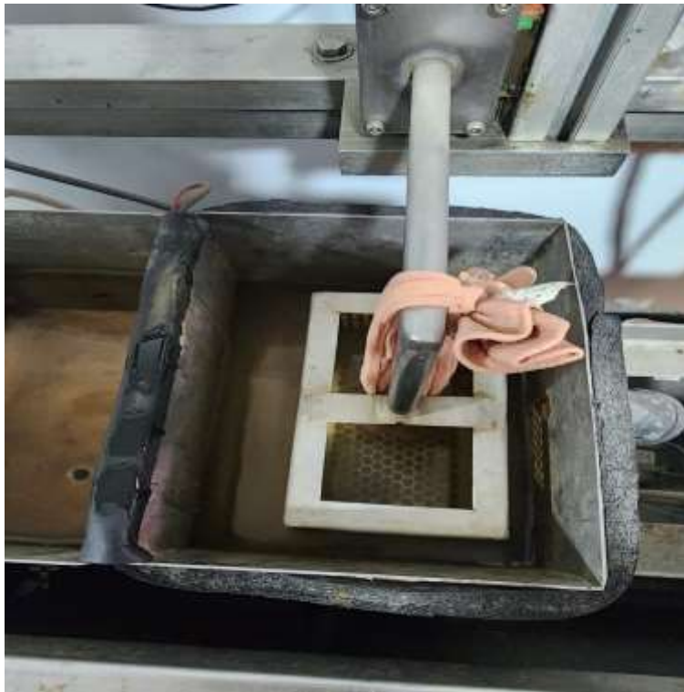
Termociclado a 2000 ciclos entre 3°C a 60°C
