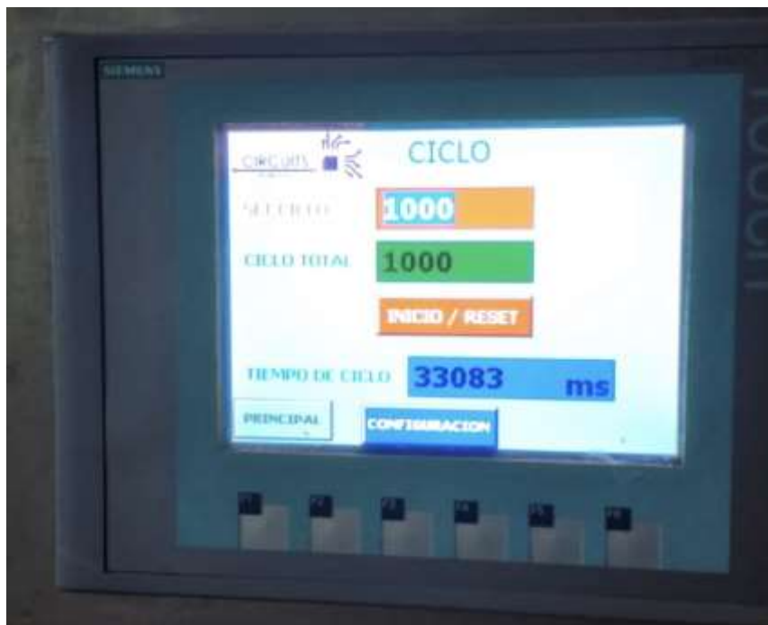
Termociclado a 2000 ciclos entre 3°C a 60°C
