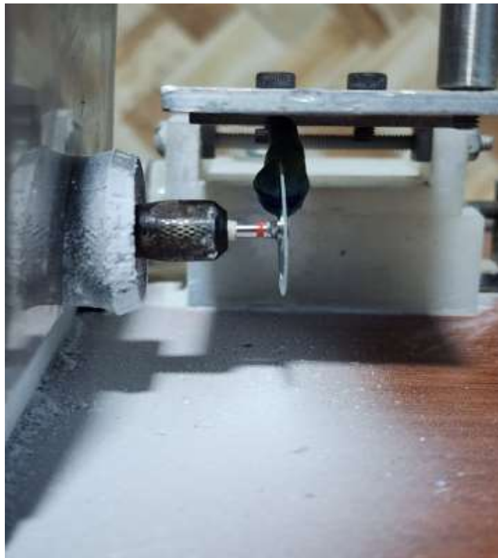
Corte vertical de las piezas dentarias con disco de diamante
