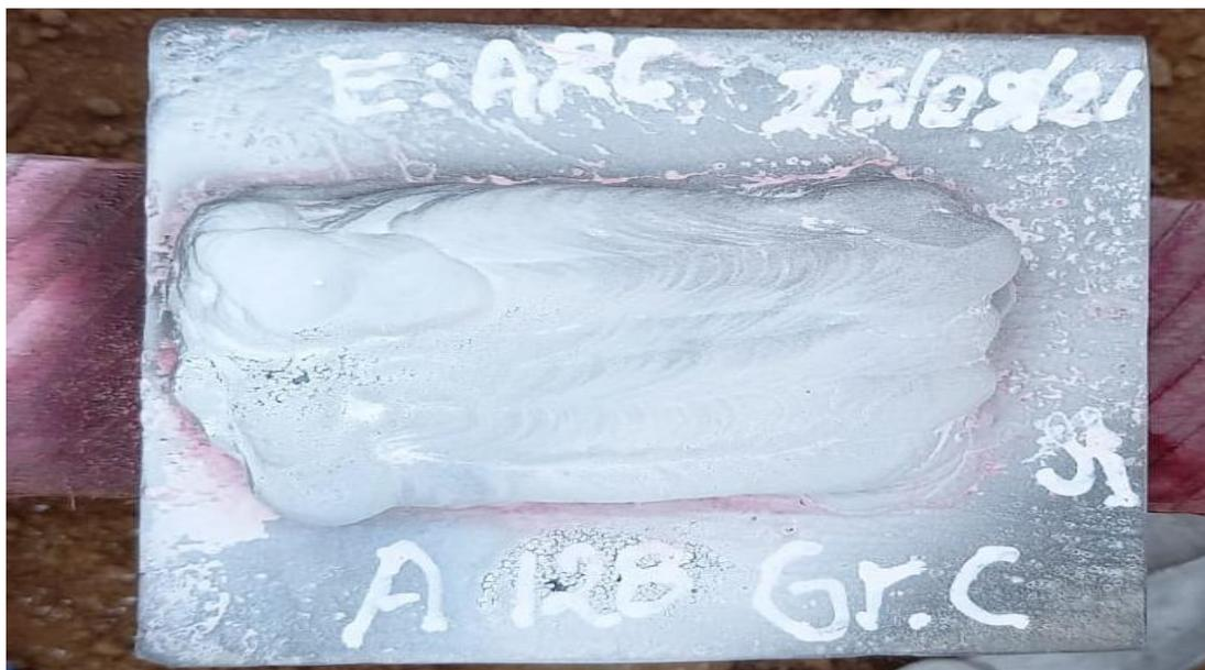
**Figura 17. Ensayo de tinte penetrante realizado al cupón soldado**
