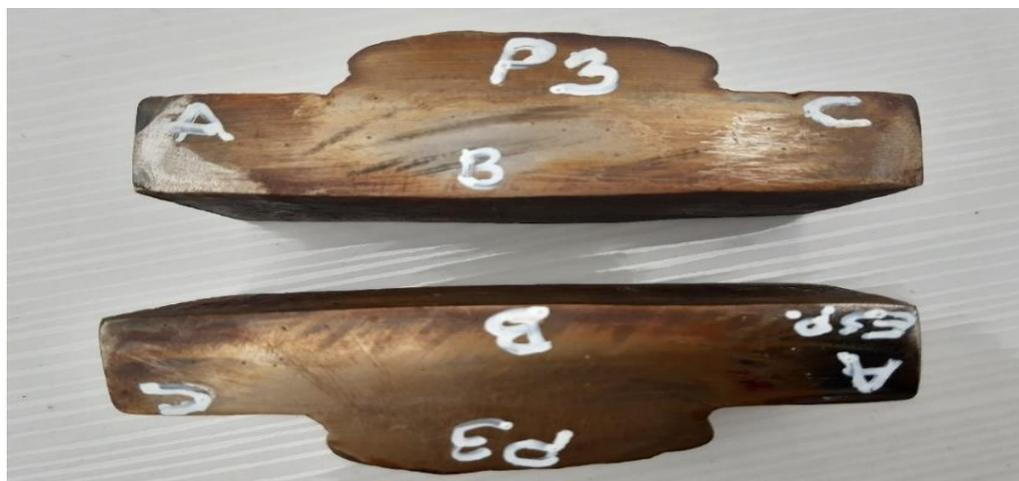
**Figura 19. Especímenes cortados transversalmente a la soldadura del cupón**
