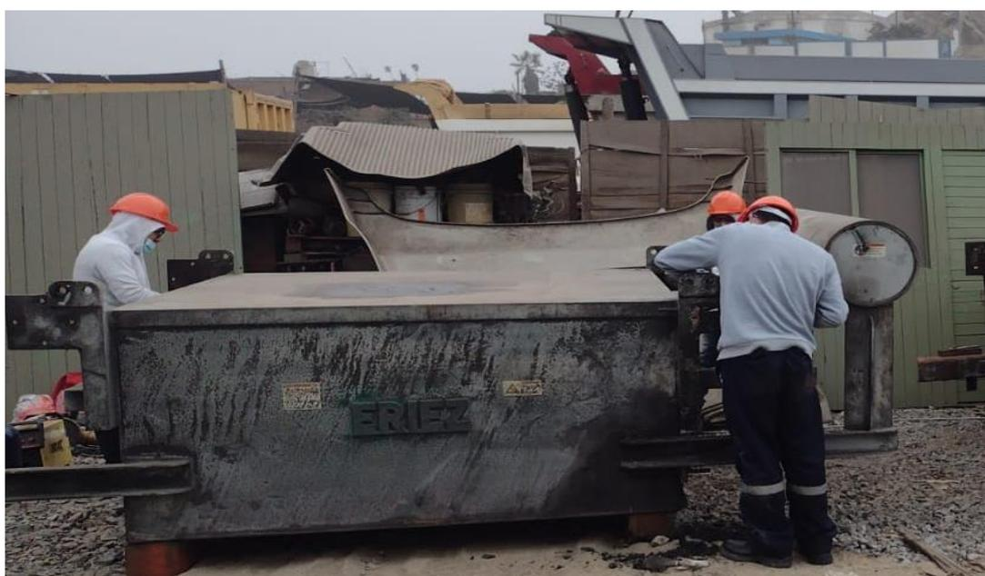
**Figura 2. Limpieza de las cajas Eriez de la capa de recubrimiento**
