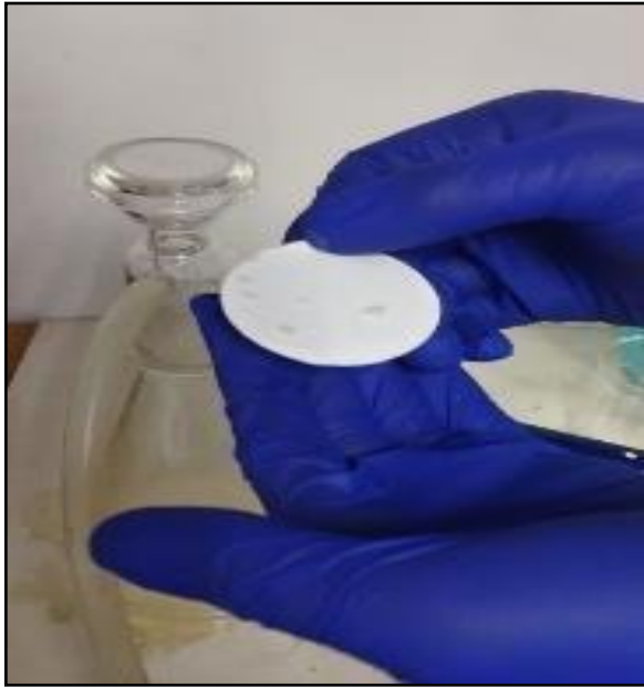
USO DEL FILTRO DE FIBRA DE VIDRIO CON TAMAÑO DE PORO DE 1.0 \mu\text{m}
