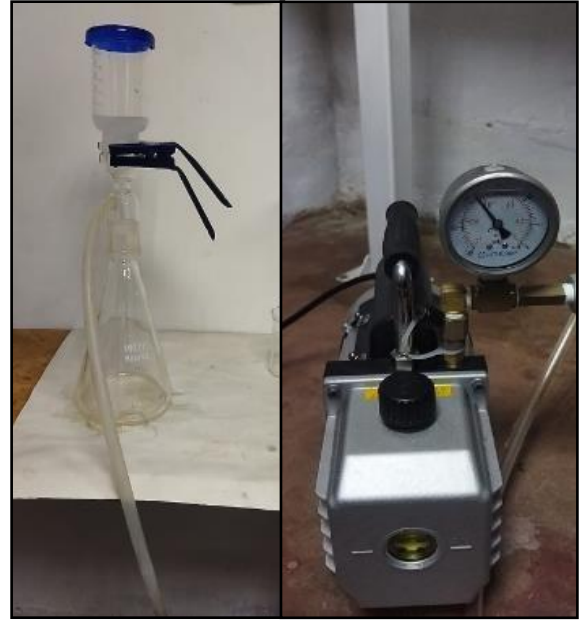
USO DEL EQUIPO DE FILTRACIÓN AL VACÍO
