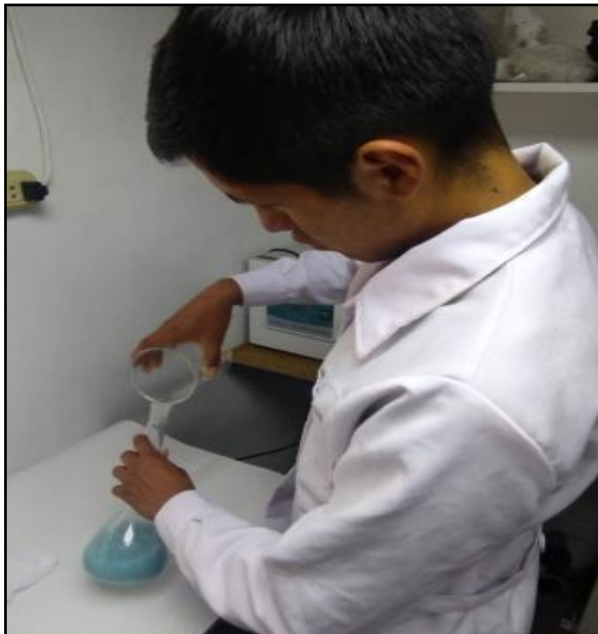
AGREGANDO AGUA DESTILADA A LA SOLUCIÓN HASTA LLEGAR A 1L, CONFORMANDO ASÍ LA SOLUCIÓN SINTÉTICA, AGITANDO
