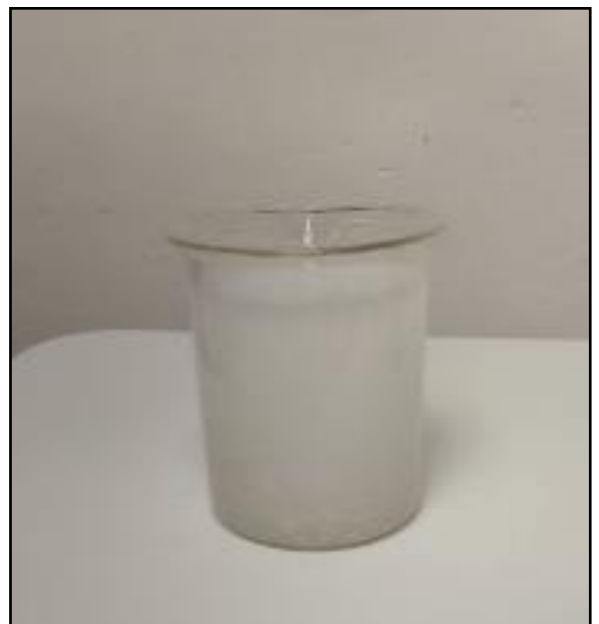
DESPUÉS DEL TIEMPO DE AGITACIÓN SE OBSERVA UNA SEPARACIÓN, PRECIPITADO EN LA SOLUCIÓN SINTÉTICA DESPUÉS DE USAR EL AMONIO CUATERNARIO
