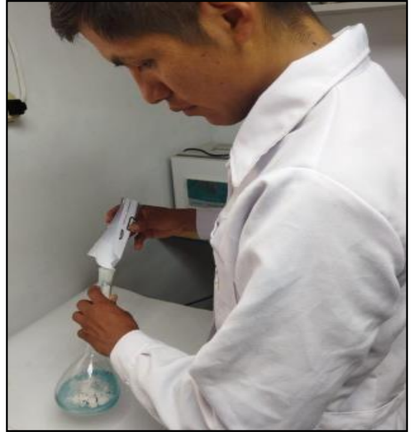
AGREGANDO EL CIANURO DE SODIO, OXIDO DE CALCIO A LA SOLUCIÓN
