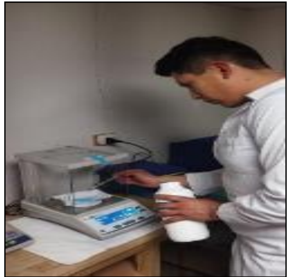
USO DE LA BALANZA ANALÍTICA PARA PESAR EL SULFATO DE COBRE PENTAHIDRATADO
