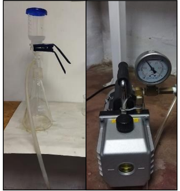
USO DEL EQUIPO DE FILTRACIÓN AL VACÍO
