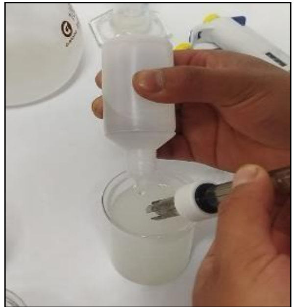
USO DEL ACIDO SULFÚRICO PARA LLEGAR A UN pH DE 8
