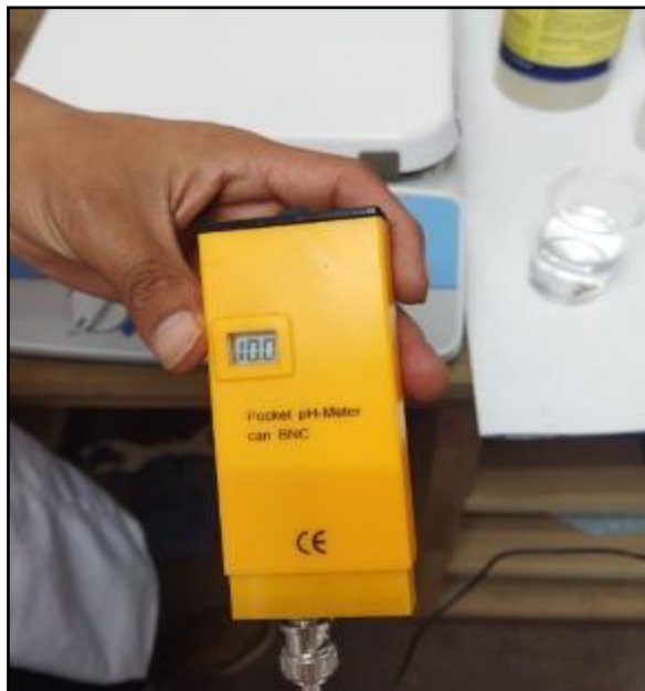
USO DEL MEDIDOR DE PH, PARA TRABAJAR CON PH A 10 Y pH A 8
