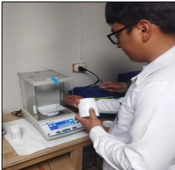
USO DE LA BALANZA ANALÍTICA PARA PESAR EL CIANURO DE SODIO, OXIDO DE CALCIO
