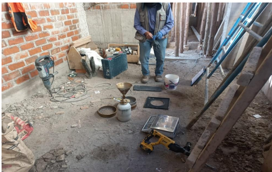
Figura 116. Prueba de densidad de campo en los ambientes interiores de los bloques.
