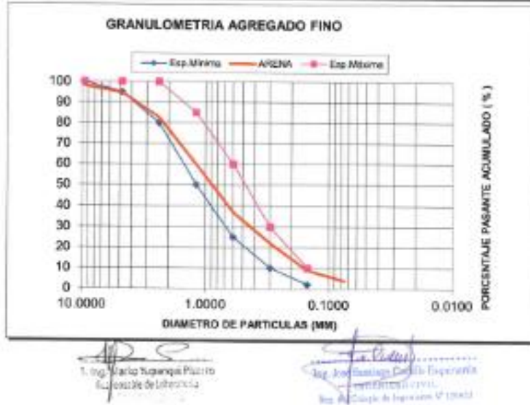
Figura 122. Efectos obtenidos de la Granulometría de agregados utilizados en obra.
