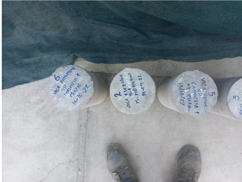
Figura 117. Fabricación de probetas para verificación de resistencia del concreto.
