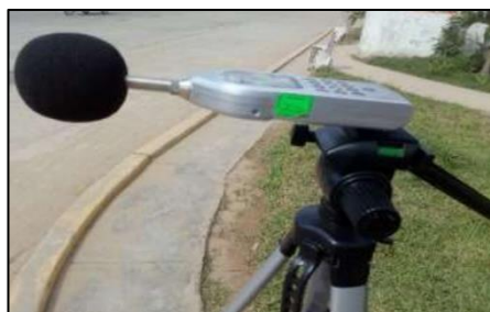
Figura 1. Sonómetro de clase 2
