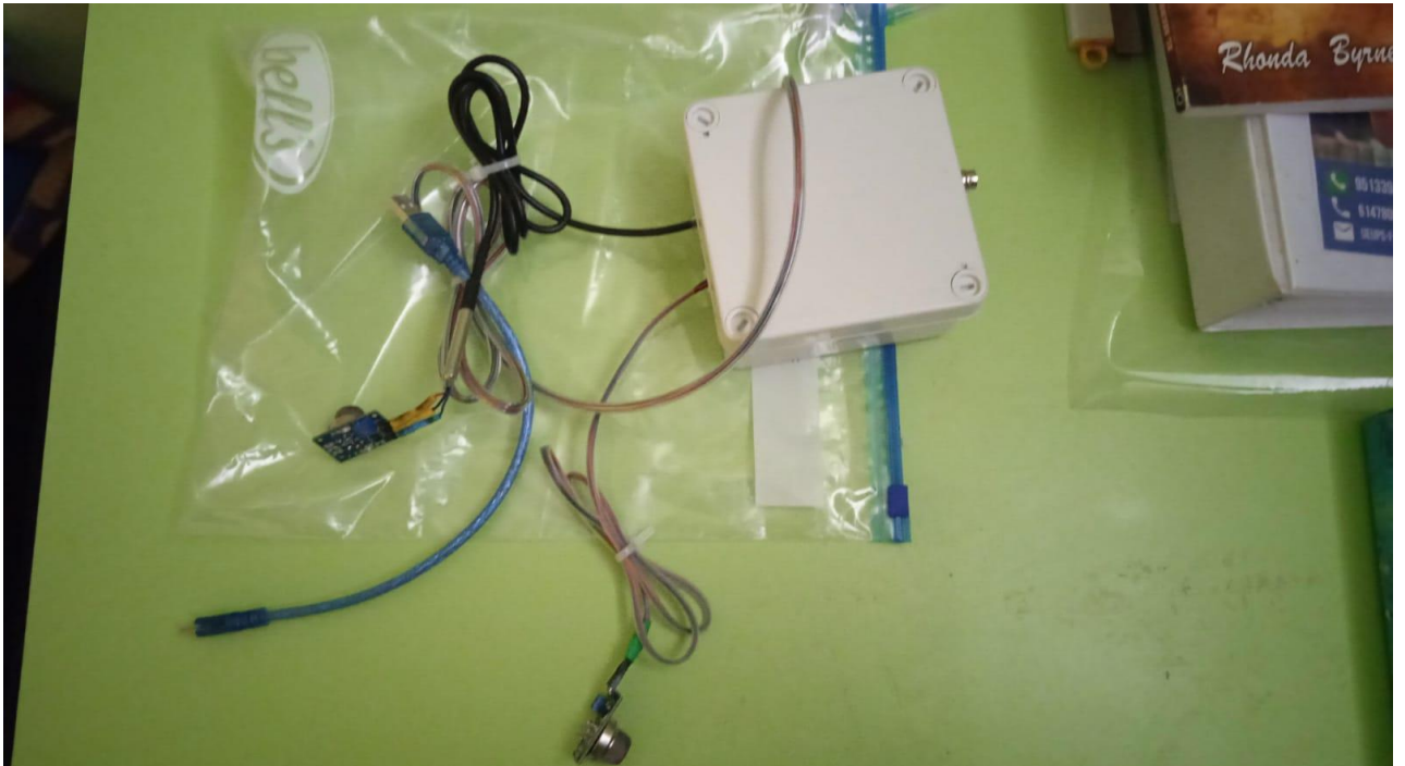
Fotografía 05. Tarjeta de Adquisición (Arduino 1-Arduino nano)
