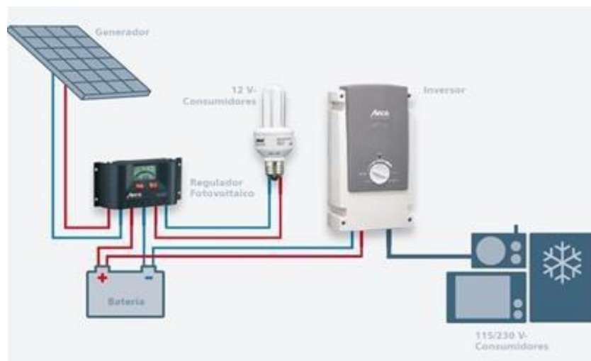
Figura 4. Esquema de un sistema aislado (18)
