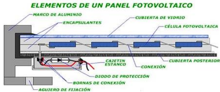
Figura 7. Componentes del panel solar (16)
