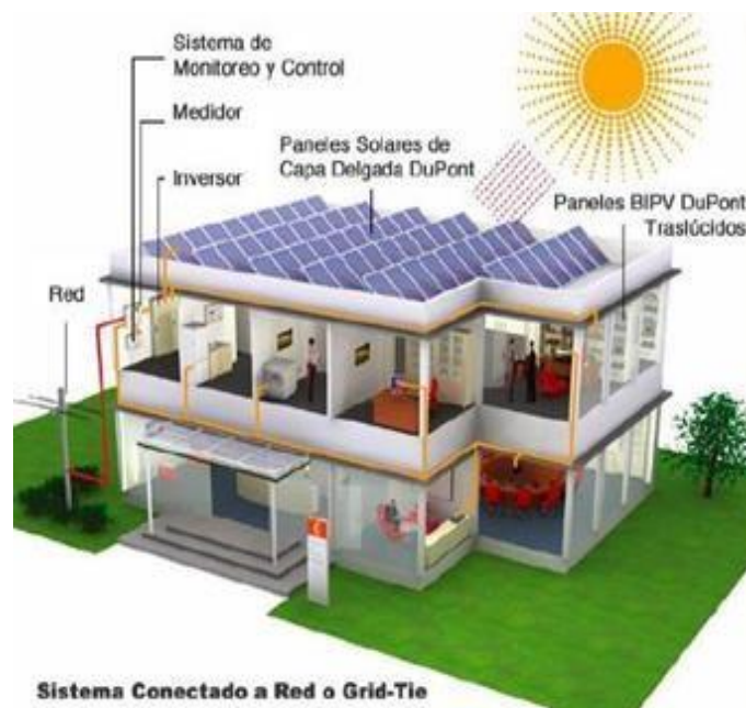
Figura 5. Esquema de un sistema conectado a la red visión Energy (20)
