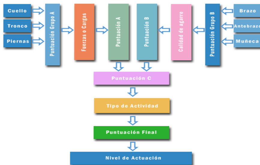
Figura 1. Procedimiento para la obtención del nivel de actuación en el método REBA
