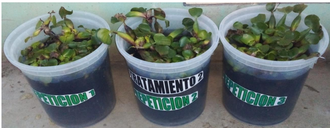
Fotografías 11 y 12. Fitorremediación de aguas industriales mineras a base de lechuga de agua ( Pistia stratiotes ) durante 45 días.
