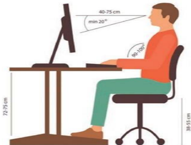
Figura 1. Posición recomendada para usar un dispositivo VDT (24)
