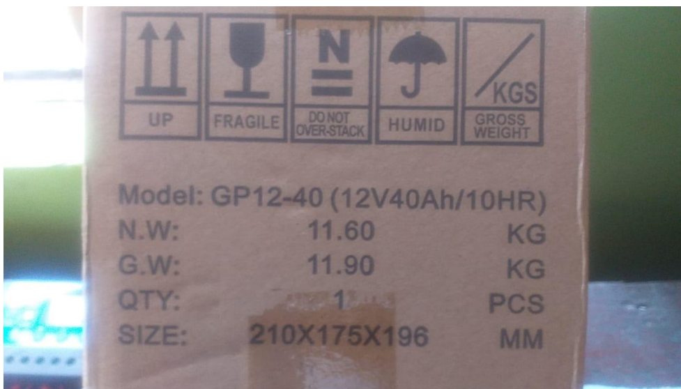
Figura 35. Características de la Batería KAZO. Tomado por el autor.
