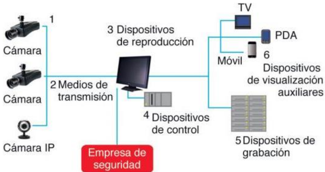
Figura 3. Componentes de un sistema de video vigilancia. Tomado de “Sistemas de producción audiovisual” elaborado por Iván Guerrero.
