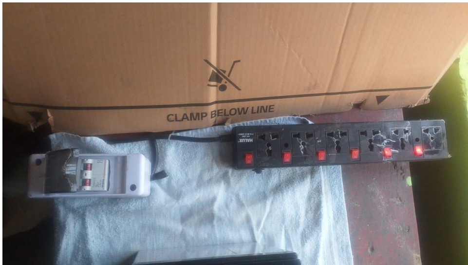
Figura 37. Interruptor Termo magnético 2X32A 10Ka/400V FN820YC32 NE + Extensión 6 Tomas Universal. Tomado por el autor.
