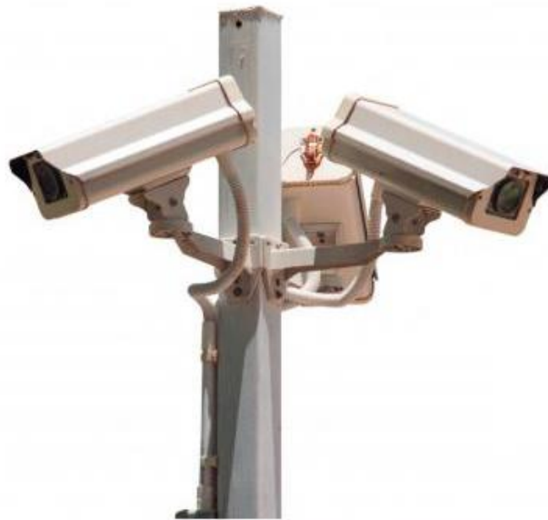
Figura 5. Cámara de video vigilancia con soporte y carcasa de protección. Tomado de “Sistemas de producción audiovisual” elaborado por Iván Guerrero.
