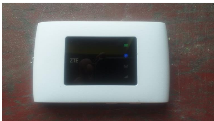
Figura 39. Modem ZTE MF920U. Tomado por el autor.
