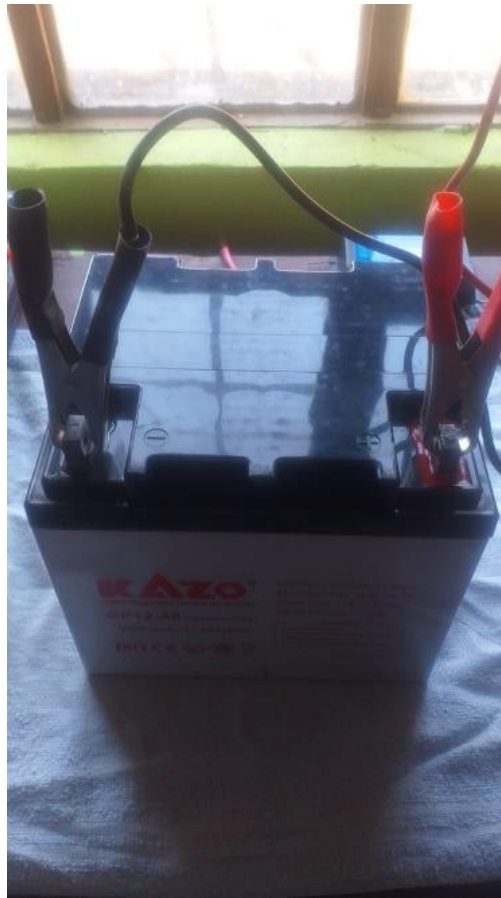
Figura 62. Instalación de la Batería KAZO GP12-40. Tomado por el autor.
