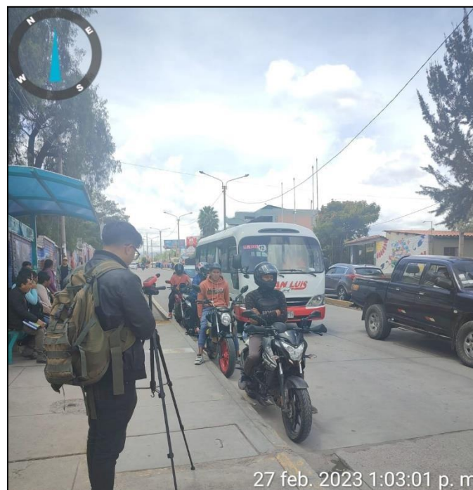
Figura 12. Medición del nivel de ruido en la Av. Independencia
