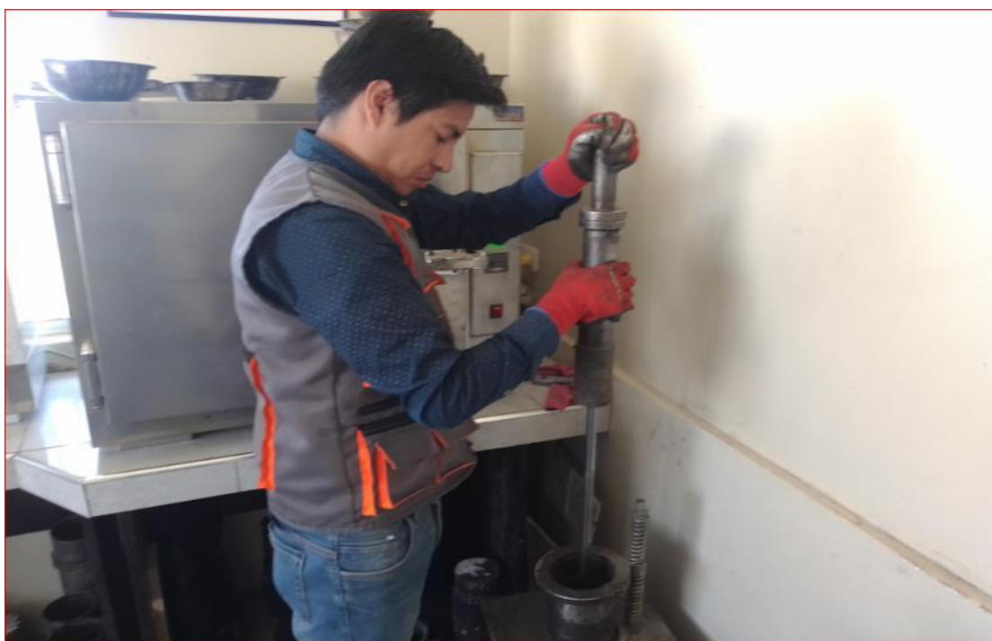
Anexo 16: Colocado en forma vertical del martillo Marshall antes de iniciar la compactación.
