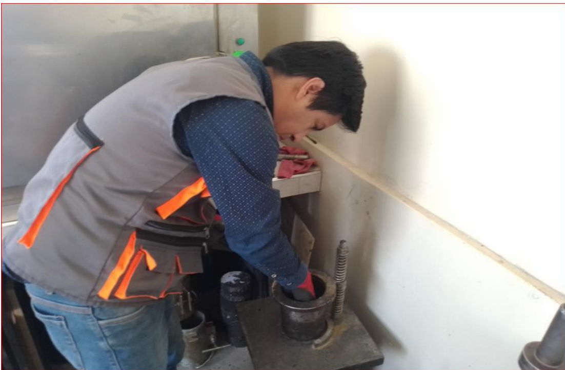
Anexo 10: Armado del molde con el collarín con ayuda del sujetador Marshall.
