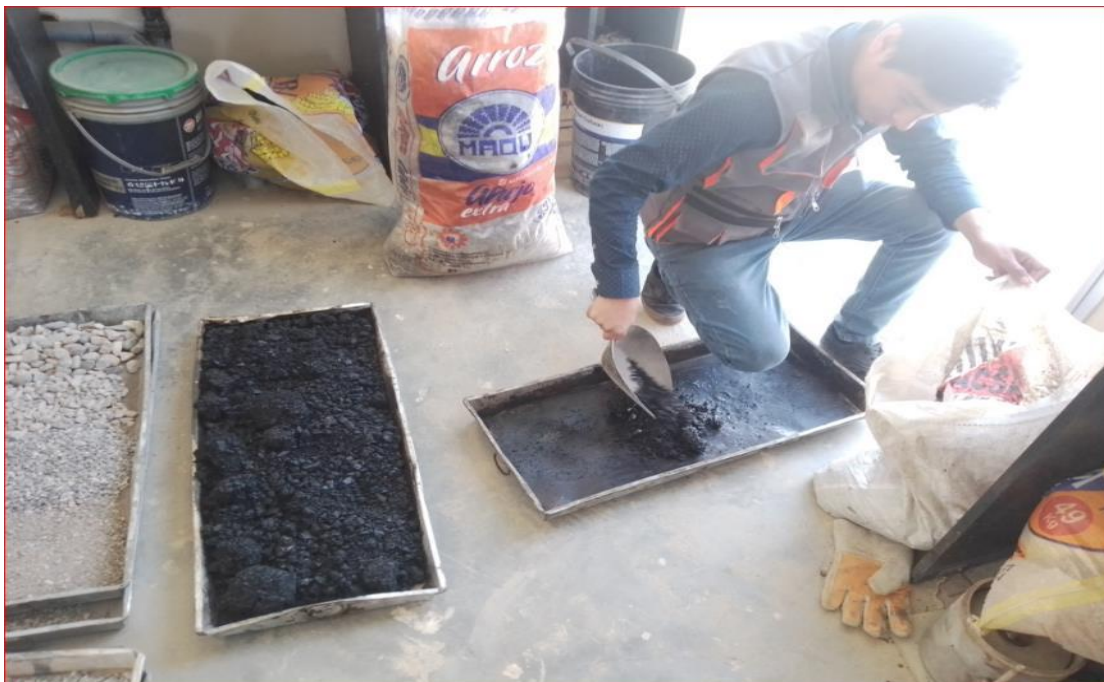
Anexo 2: Colocado de la mezcla premezclada sobre bandejas de acero inoxidable.
