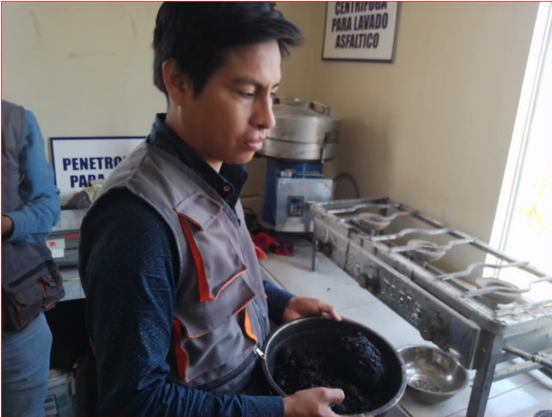
Anexo 5: Mezcla premezclada para pesado de 1250 gr. para el ensayo Marshall.
