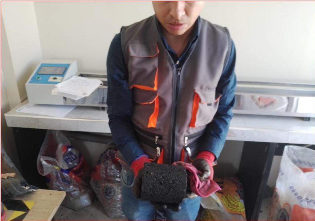
Anexo 41: Presentación de las probetas de 101.6 mm de diámetro y 101.6 mm de altura
