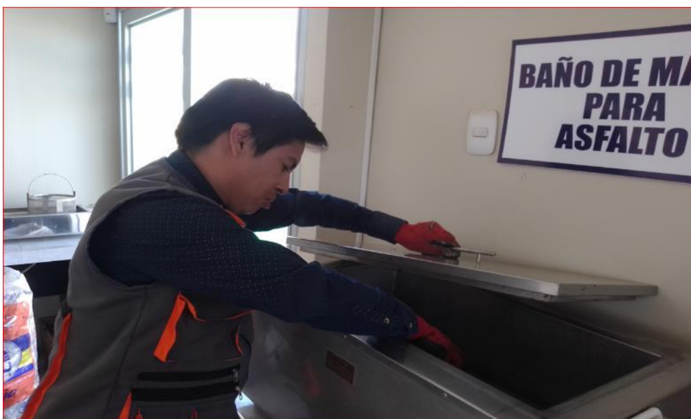
Figura 3: Baño a María del molde para el ensayo Marshall
