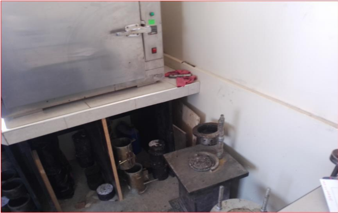
Anexo 8: Pedestal de compactación donde se compactará el molde de la mezcla asfáltica premezclada
