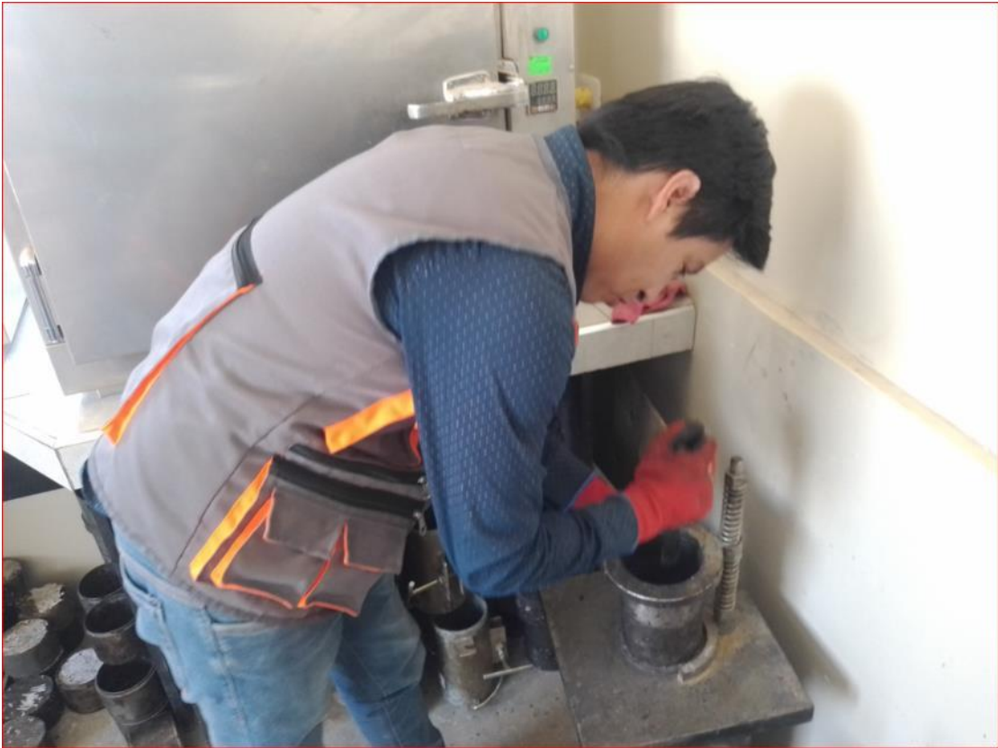
Anexo 14: Chuseado de la muestra con 15 golpes externos y 10 golpes internos en forma vertical.
