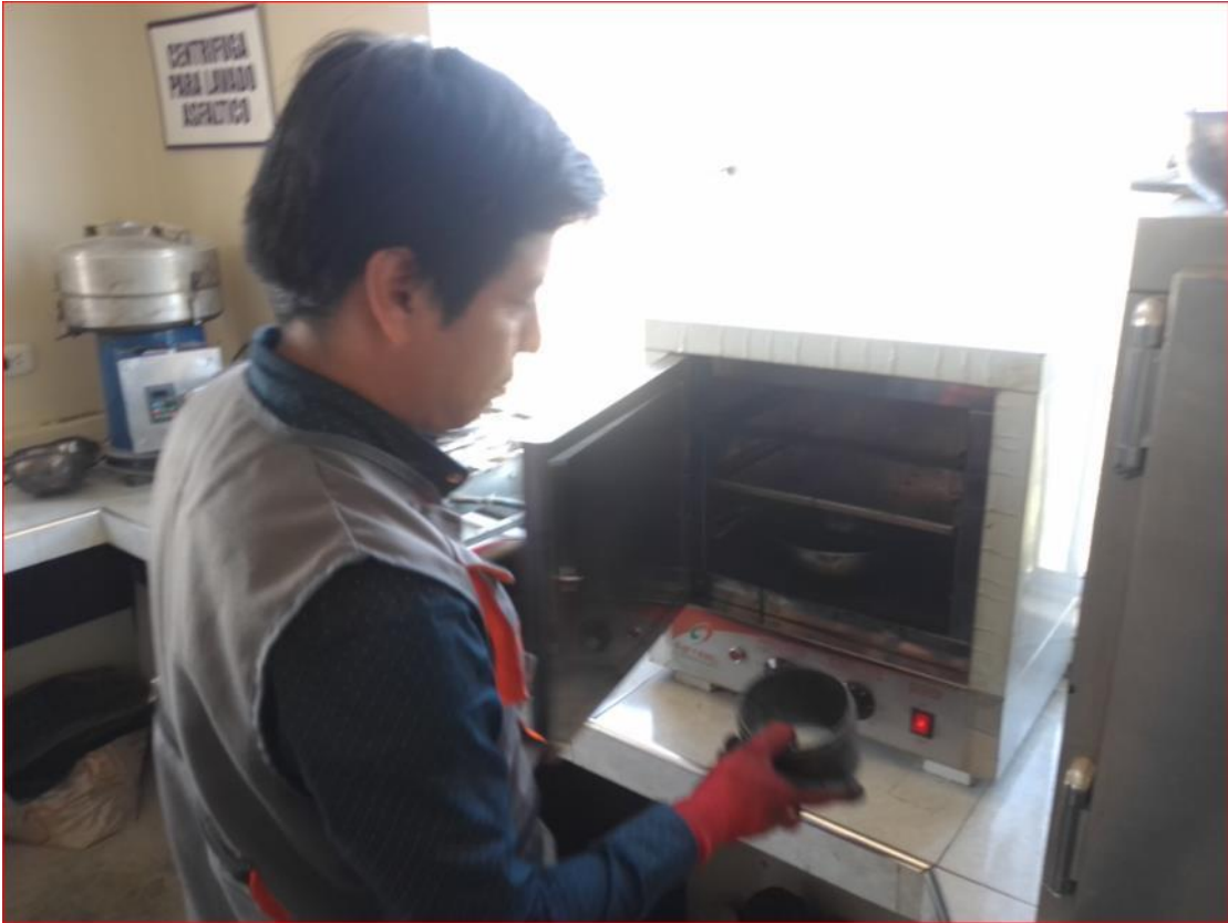
Anexo 7: Presentación del molde de una briqueta para el ensayo Marshall.
