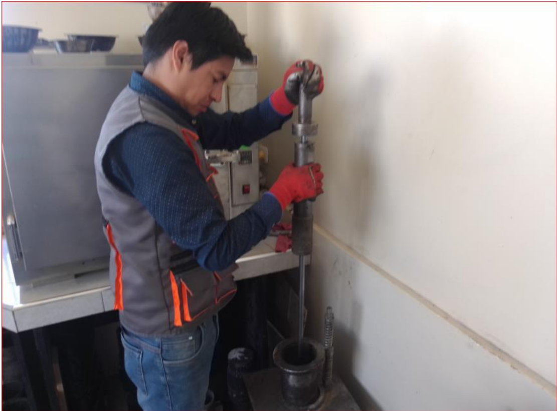
Figura 6. Compactación de la mezcla asfáltica.
