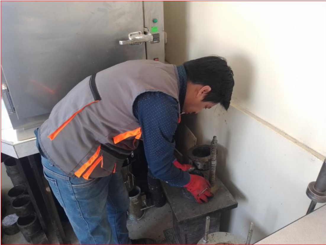
Anexo 9: Colocado de la base y el molde de la probeta en el pedestal Marshall.
