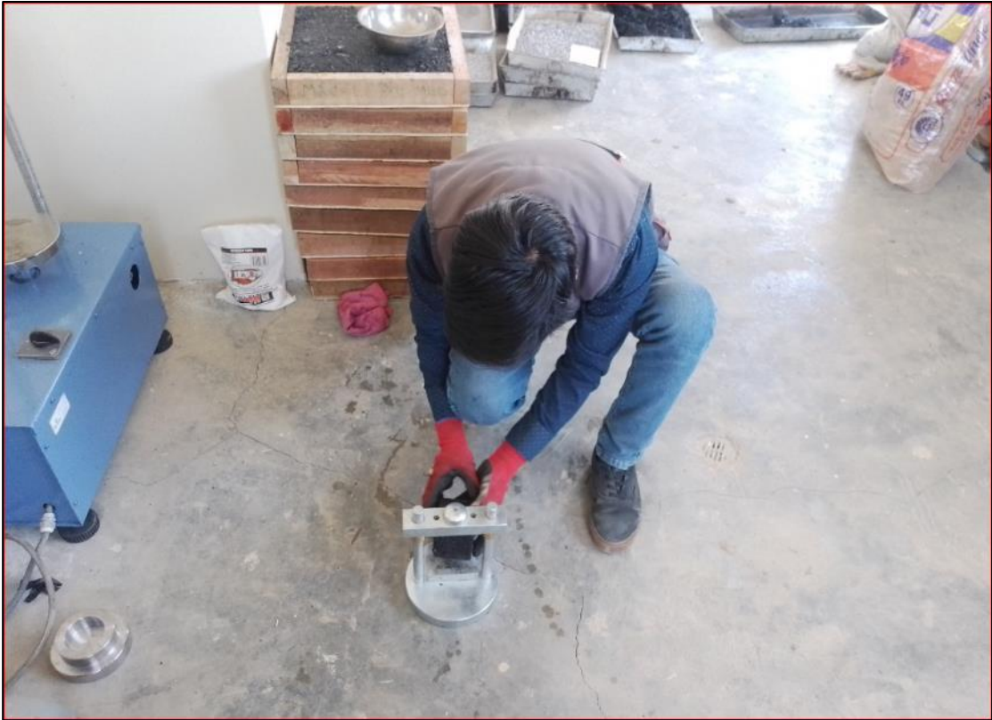
Figura 5. Mordaza Lottman para el ensayo de tracción indirecta
