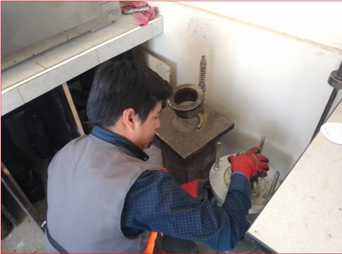
Anexo 25: Al manipular la prensa hidráulica se debe separar el molde de la probeta.
