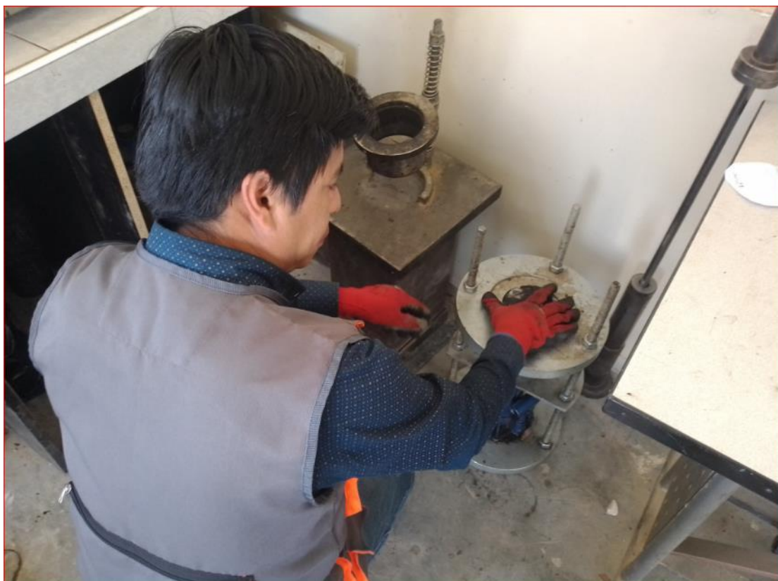
Anexo 24: Colocado del molde en la prensa hidráulica.
