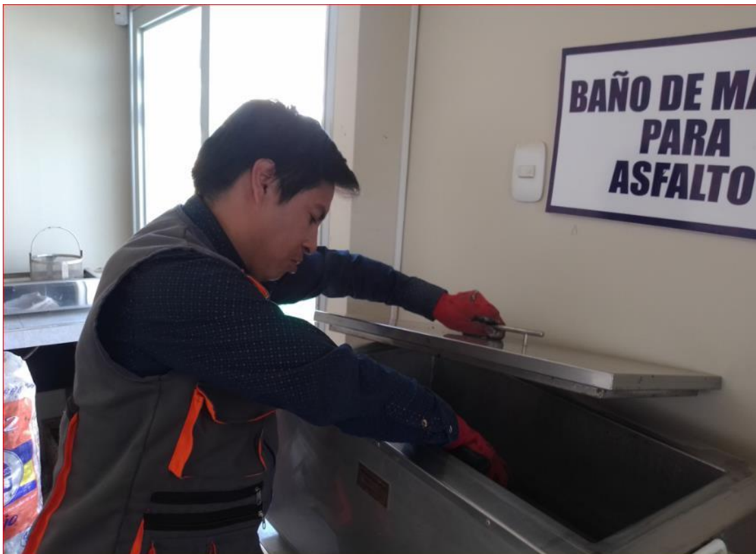
Anexo 28: El tiempo que debe estar la probeta en baño a María es de 30 minutos.
