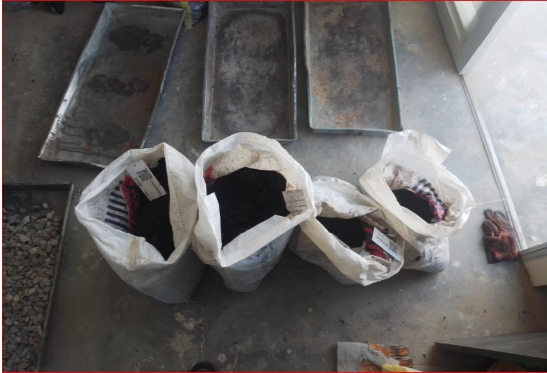
Anexo 1: Recepción de la mezcla asfáltica premezclada
