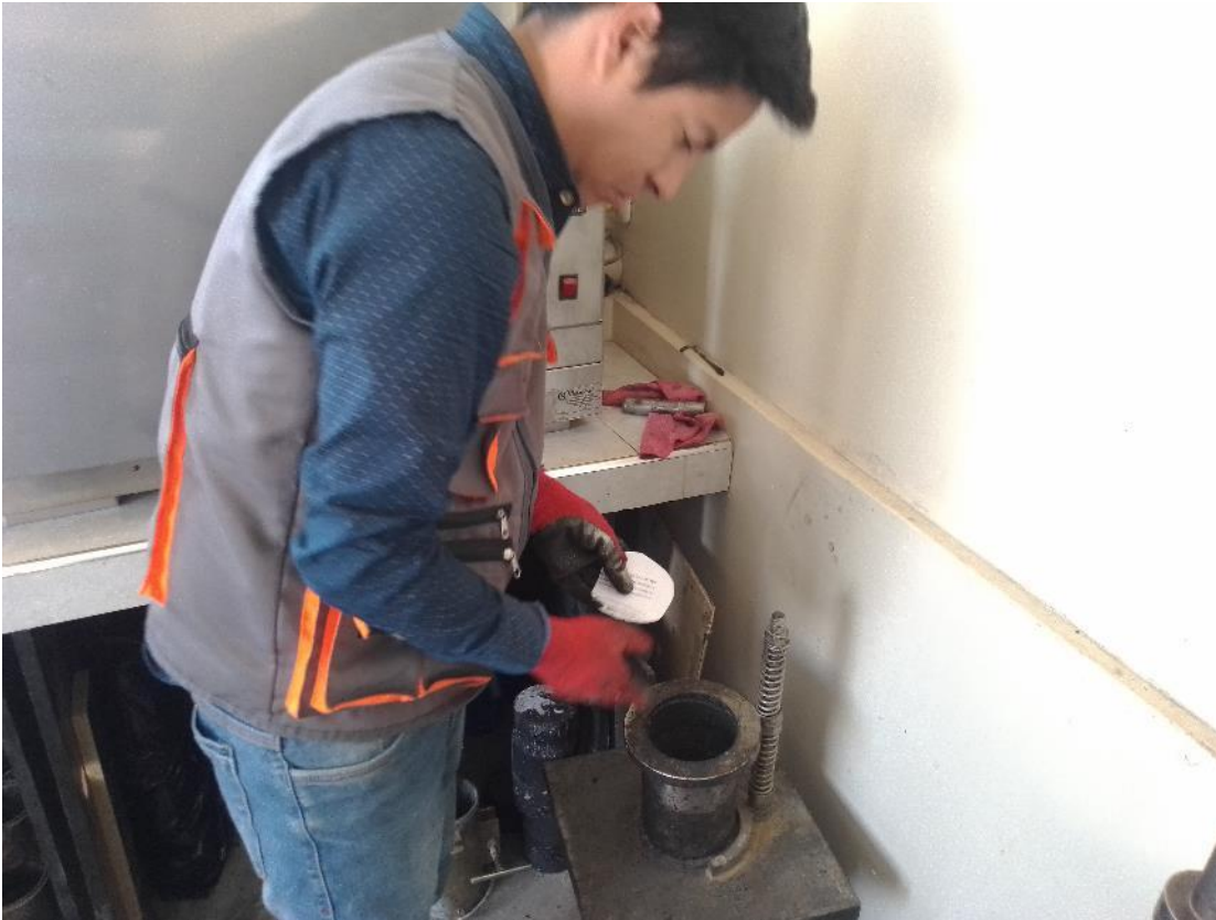
Anexo 11: Colocado del papel filtro en la base del molde.
