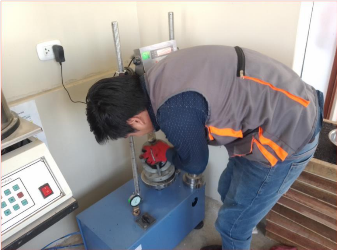
Anexo 33: La mordaza Marshall se debe colocar al centro de la base de la prensa Marshall.
