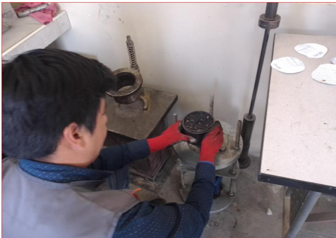
Anexo 23: Prensa hidráulica que permitirá separar el molde de la probeta de mezcla premezclada.
