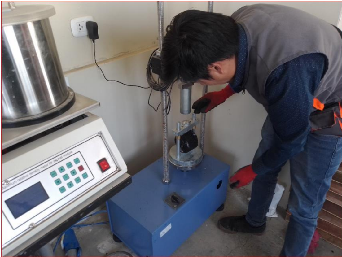
Anexo 52: Colocado de la mordaza Lottman en la parte central de la prensa
