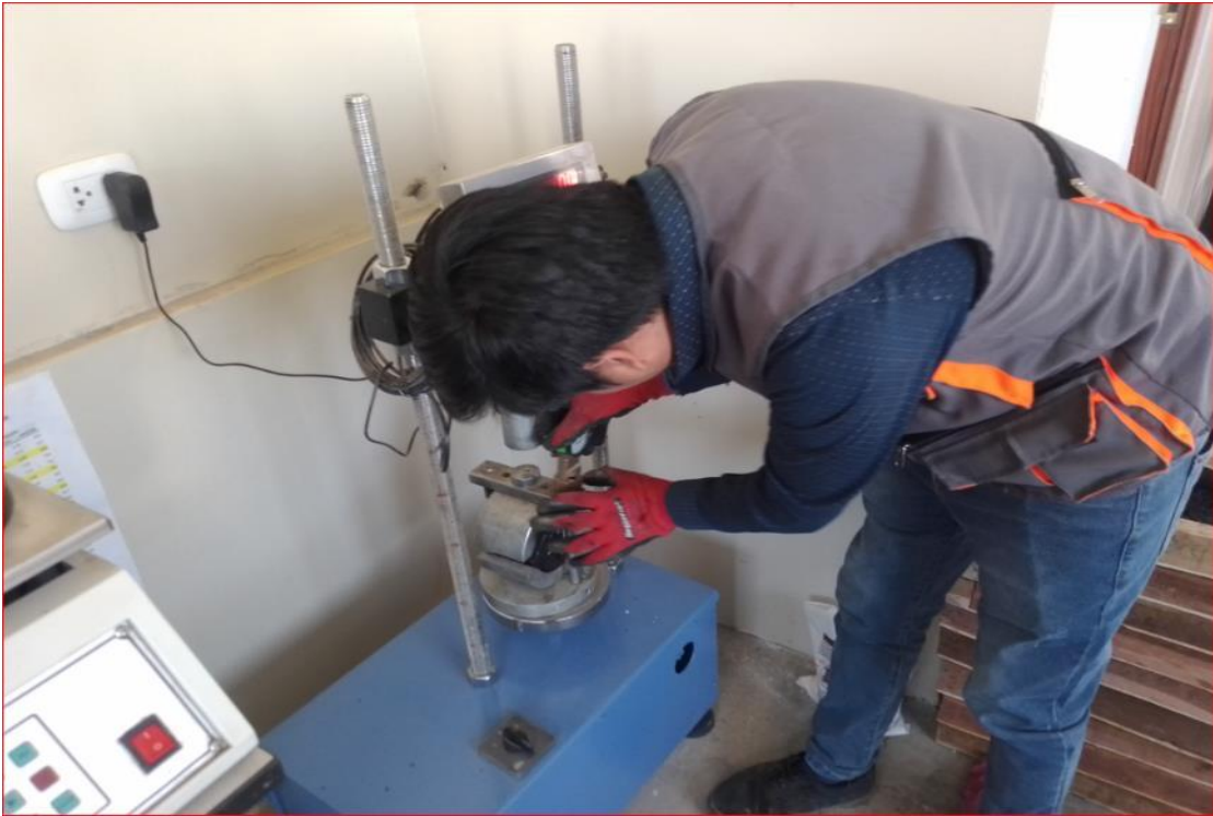
Anexo 34: Colocado del dial en la mordaza Marshall para medir la deformación.
