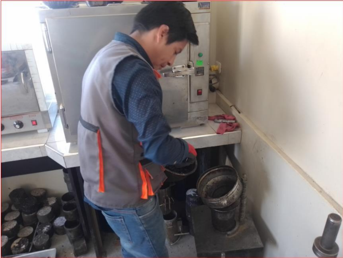
Anexo 14: Chuseado de la muestra con 15 golpes externos y 10 golpes internos en forma vertical.
