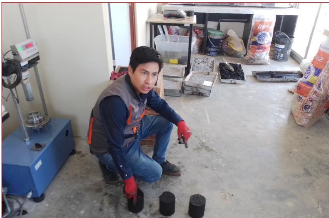
Figura 8: Presentación de los tres moldes para el ensayo de inmersión y compresión
