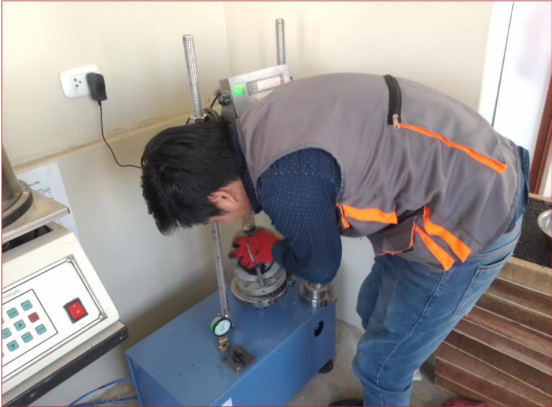
Figura 4: Prensa Marshall para determinar la estabilidad y fluencia
