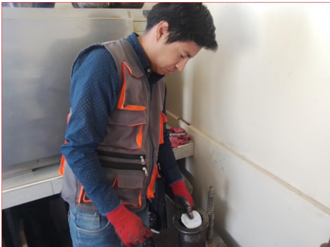
Anexo 15: Colocado del papel filtro encima del mezcla para evitar que se adhiera la muestra en el martillo Marshall.
