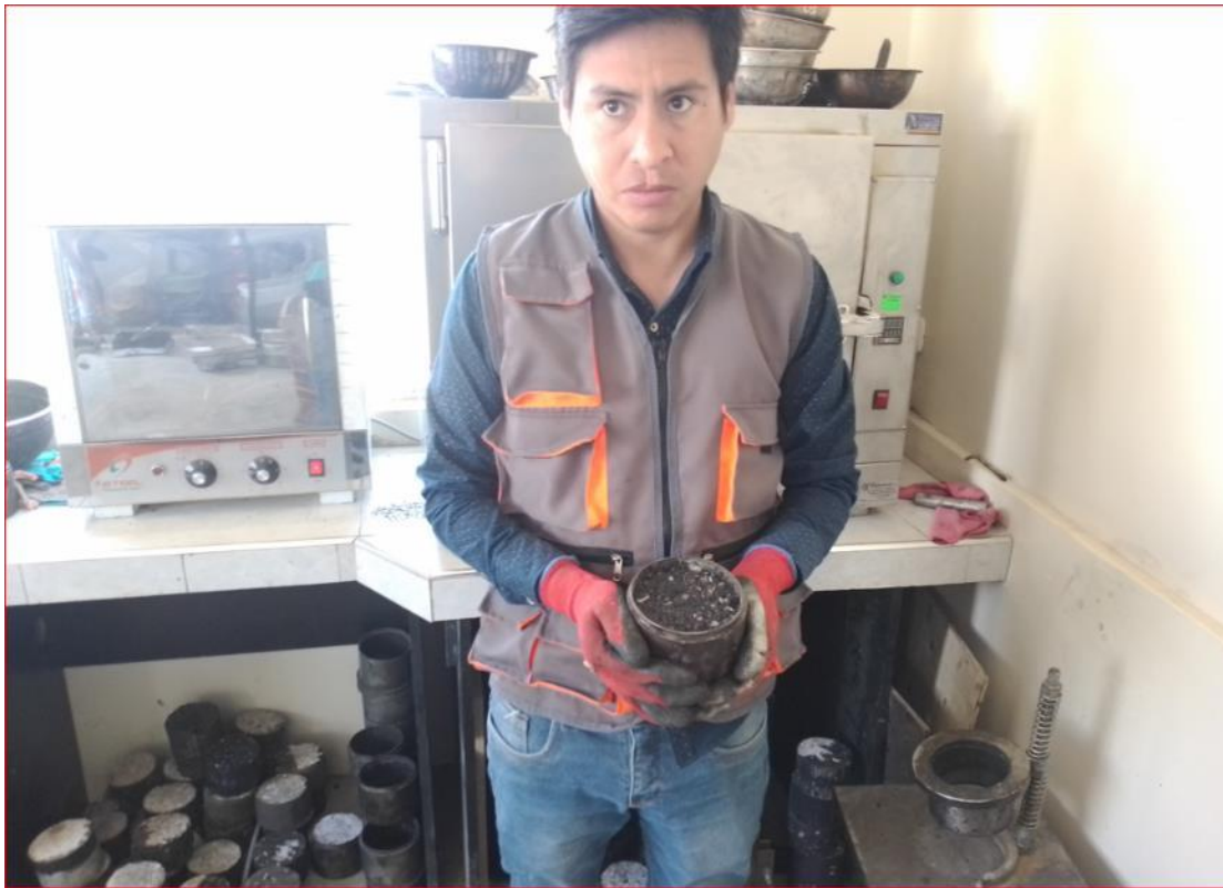
Anexo 21: Al terminar el compactado se le debe quitar el papel filtro de la probeta.
