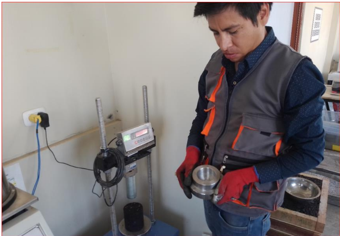
Figura 10: Prensa para calcular la resistencia de inmersión y compresión
