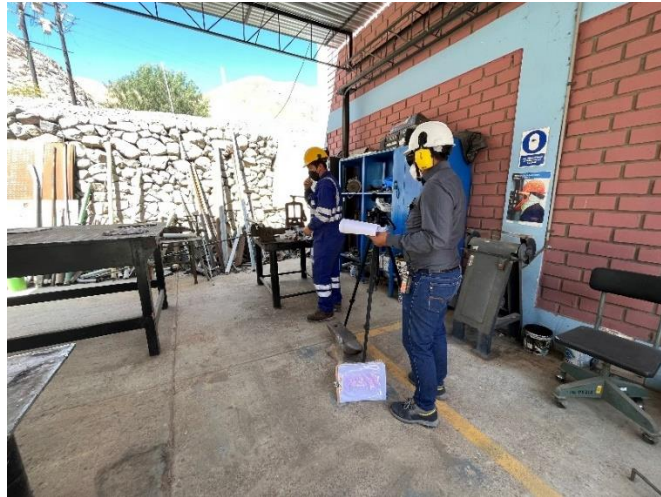
Ilustración 69 Medición de Ruido a trabajos de soldadura y esmerilado
