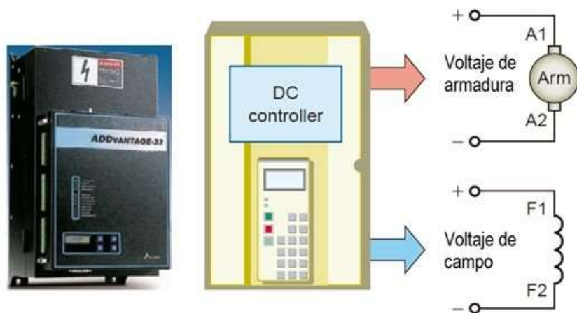
Figura 11. Motor DC excitado separadamente. Nota: Petruzella (2010, p. 94).
