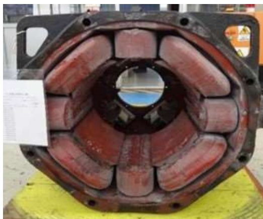
Bobinas de campo e interpolos del motor de rotación.
