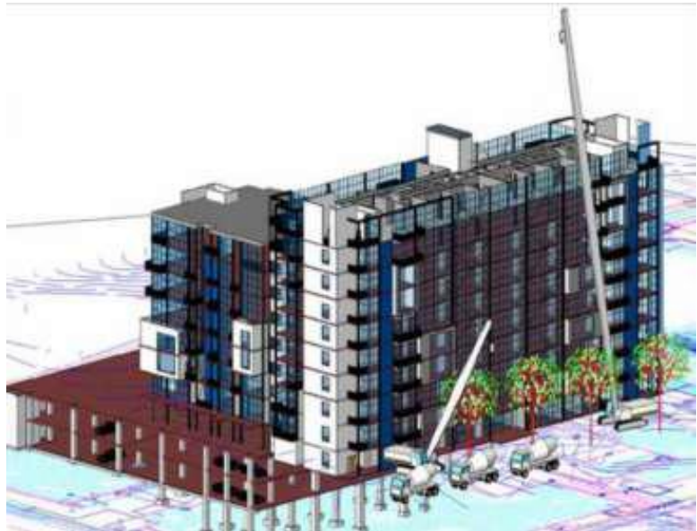
Figura 9. Proceso constructivo en un modelo BIM
