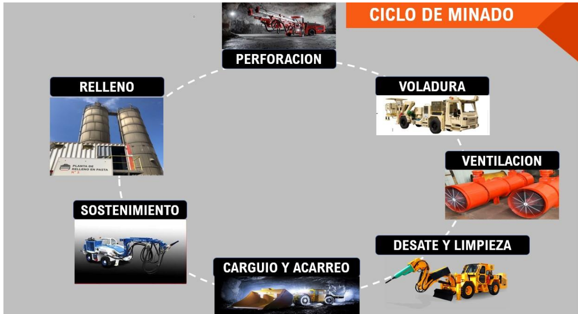
Figura 9. Ciclo de minado en la unidad minera Fuente: área de planeamiento
