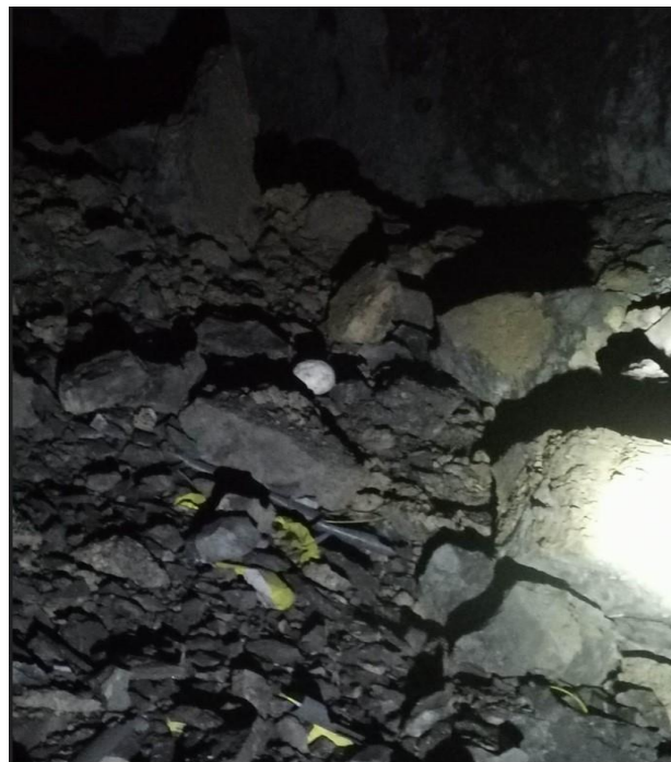
Figura 16. Granulometría post voladura, By pass 370. Fuente: propia
