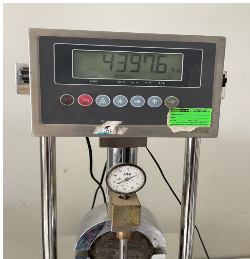
Fotografía 7. Medida de prensa detenida antes de llegar al límite
