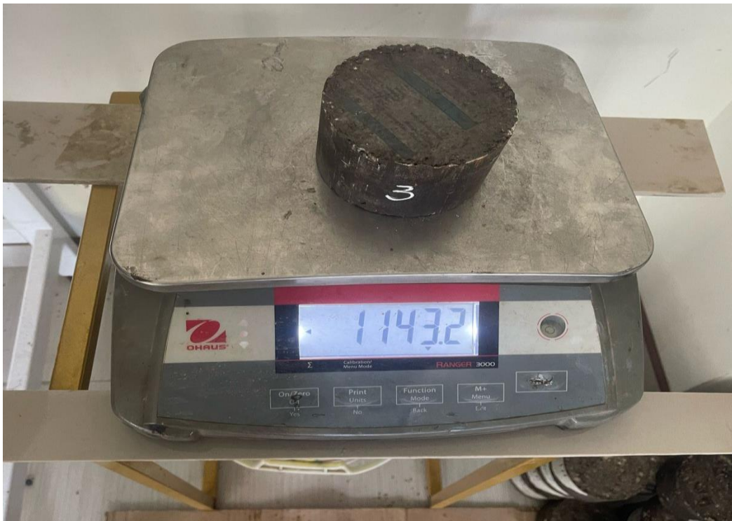
Fotografía 6. Ensayo Marshall a briquetas con resina epoxy
