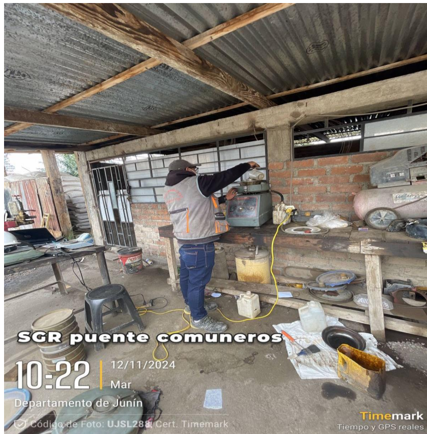
Fotografía 14. Lavado asfáltico del tipo MAC 2 al 6% de PEM
