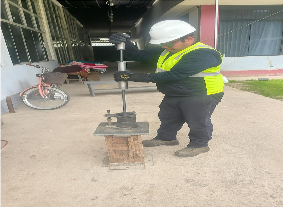
Fotografía 3. Compactación de briquetas
