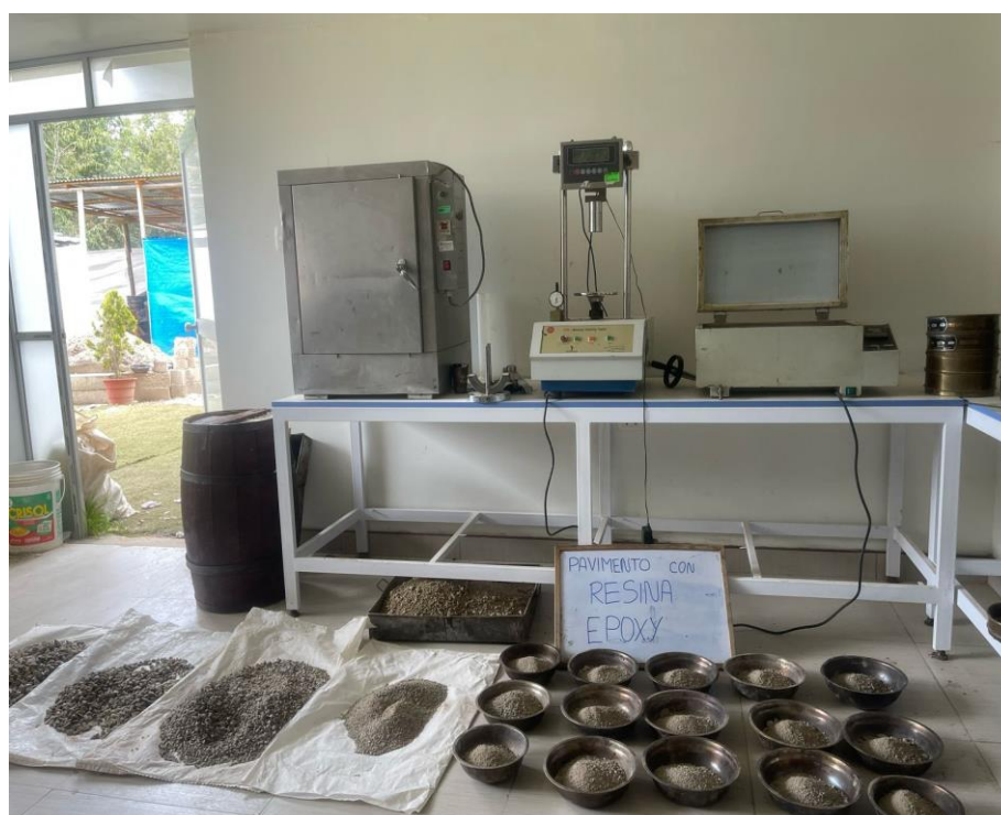
Fotografía 2: Peso y dosificación de agregados según diseño de mezcla
