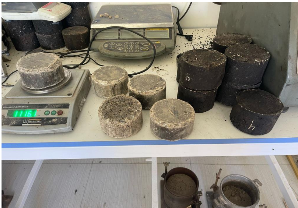
Fotografía 10. Pesando briquetas para medir el desgaste
