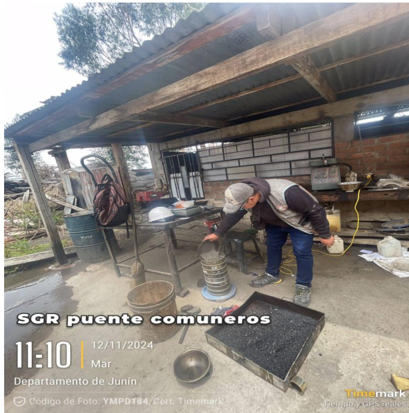
Fotografía 14. Lavado asfáltico del tipo MAC 2 al 6% de PEM
