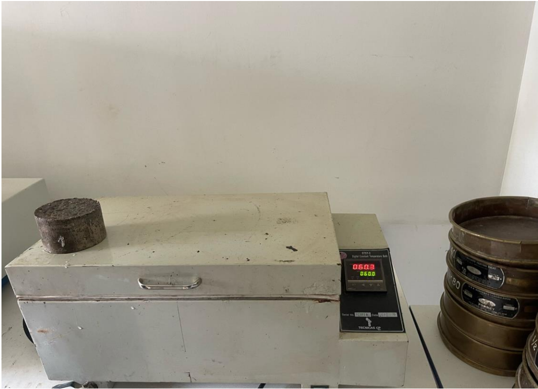
Fotografía 8. Baño maría a briquetas con resina epoxy
