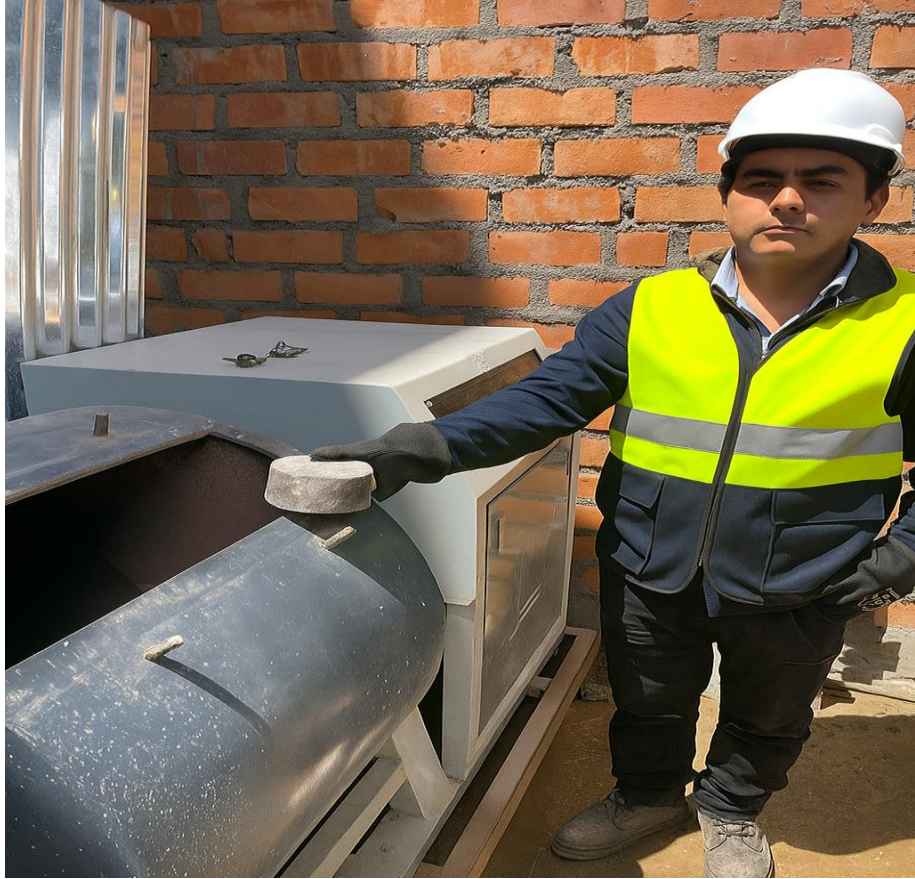
Fotografía 10. Pesando briquetas para medir el desgaste
