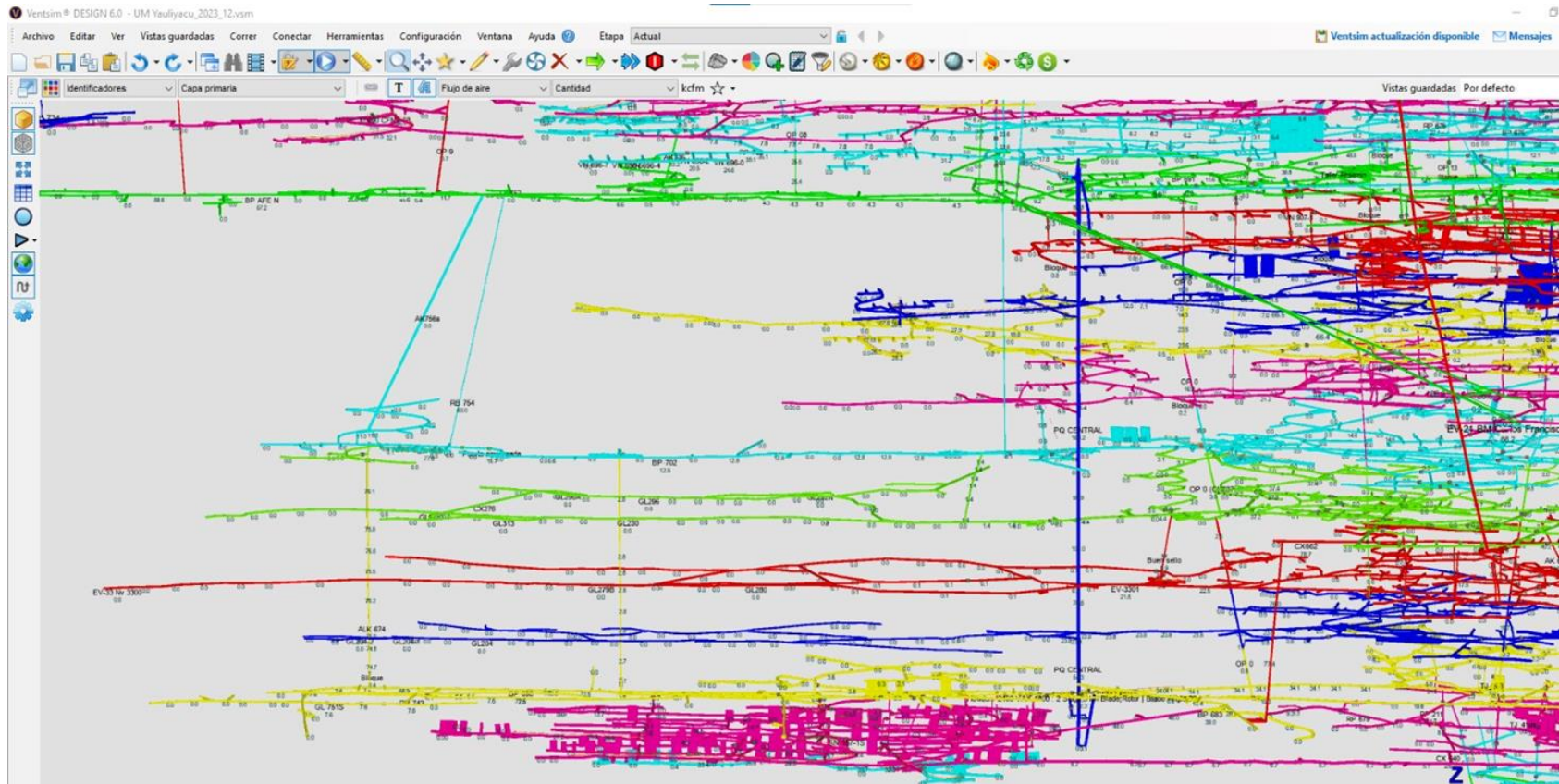
Figura 22. Vista de frente y modelado en el software Ventsim del circuito de ventilación de la unidad minera
