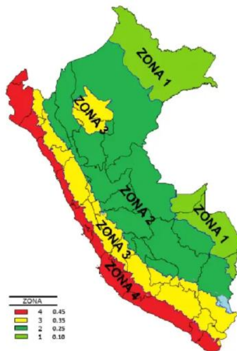
Figura 15 - Zonas Sísmicas de Territorio Peruano. Tomada de «Reglamento Nacional de Edificaciones – E.030», por Ministerio de Vivienda, Construcción y Saneamiento. 2018, p. 10
