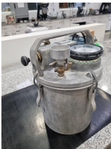
Figura 51. Equipo de Tipo B, para calcular la cantidad de aire presente en el hormigón fresco.
