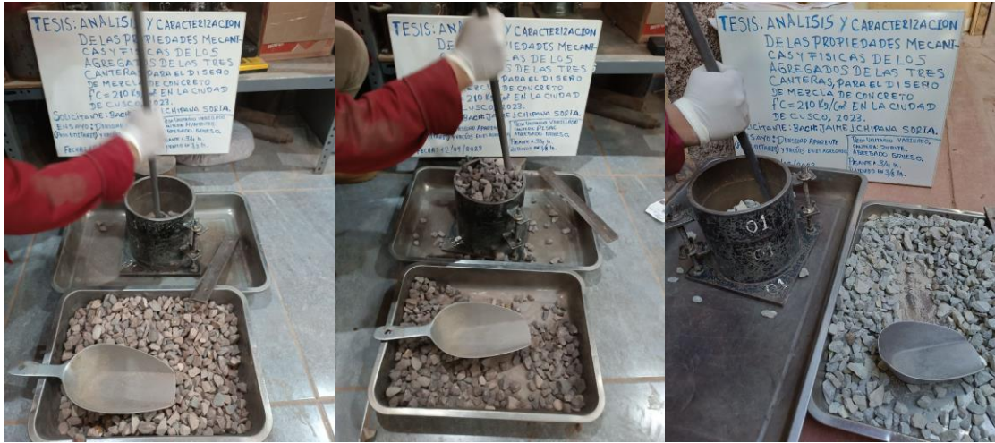
Figura 30. Rellenado y varillado del material grueso en el molde de las tres canteras Huambutio Pisac y Zurite.
