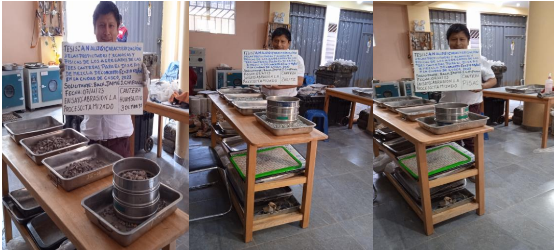
Figura 36. Cribado del árido grueso de tres canteras: Huambutio Pisac y Zurite.
