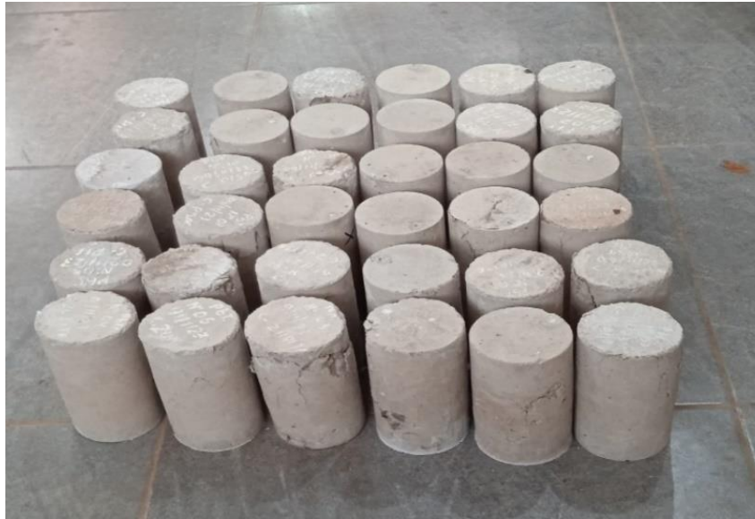
Figura 58. Muestras del hormigón en forma de cilindro procedentes de las tres canteras Zurite, Pisac y Huambutio.
