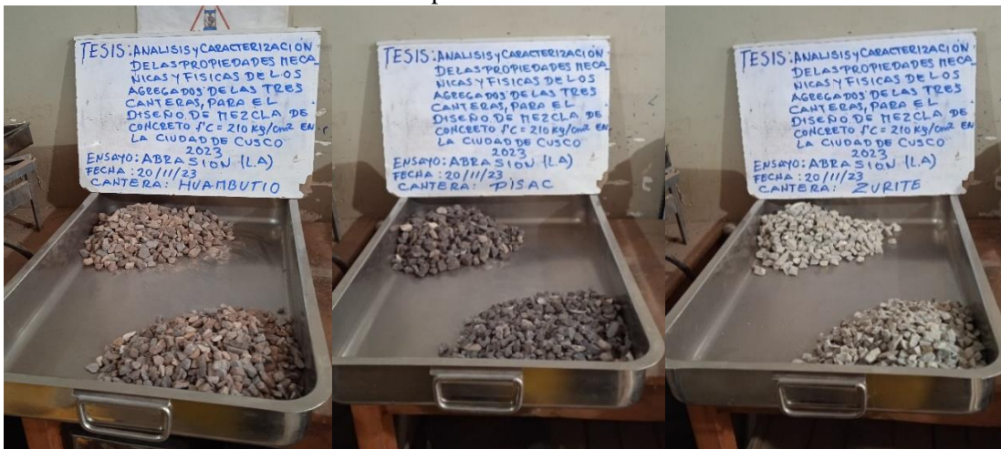
Figura 37. Separación del material grueso de las tres canteras Huambutio Pisac y Zurite.
