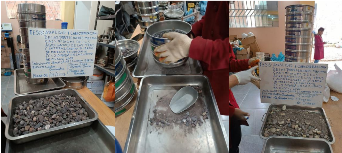
Figura 13. Clasificación mediante el tamizado de agregados gruesos, de las canteras Huambutio, Pisac y Zurite.
