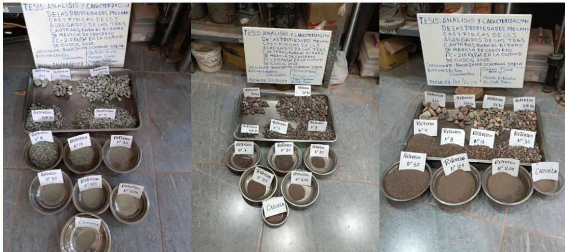
Figura 14. Muestra granulometría del agregado grueso retenido en los tamices, de las canteras Huambutio, Pisac y Zurite.
