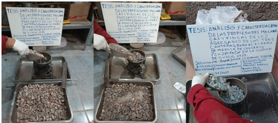
Figura 24. Llenado del recipiente con material grueso de las tres canteras Huambutio, Pisac y Zurite.
