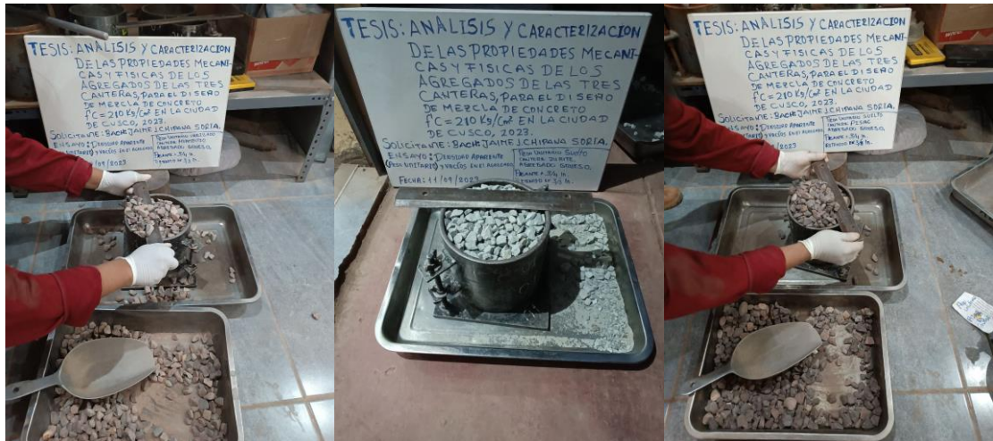
Figura 23. Enrasado del agregado grueso de las tres canteras Huambutio, Pisac y Zurite.
