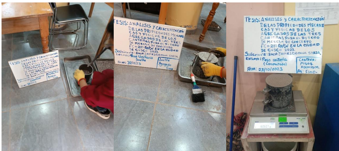
Figura 33. Relleno y Varillado del material fino en el molde de las tres canteras Huambutio Pisac y Zurite.
