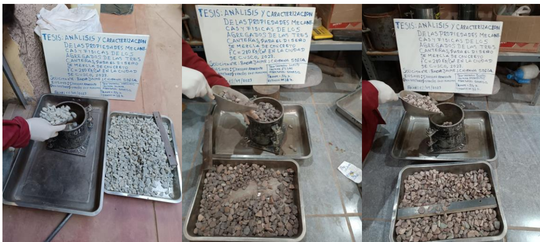
Figura 22. Rellenado del molde con agregado grueso de las tres canteras Huambutio 3 de mayo 95, Pisac y Zurite.
