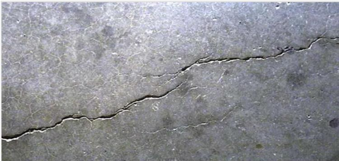
Figura 6. Retracción es el acortamiento que experimenta el concreto durante el proceso de endurecimiento y secado. Tomado de https://360enconcreto.com/blog/detalle/que-sabes-de-la-contraccion-retraccion-del-concreto/
