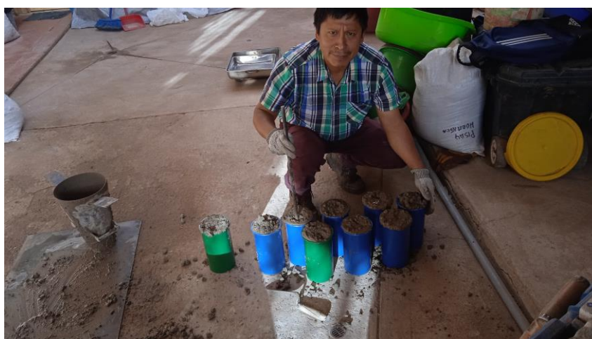
Figura 52. Colocado de concreto en los moldes cilíndricos.
