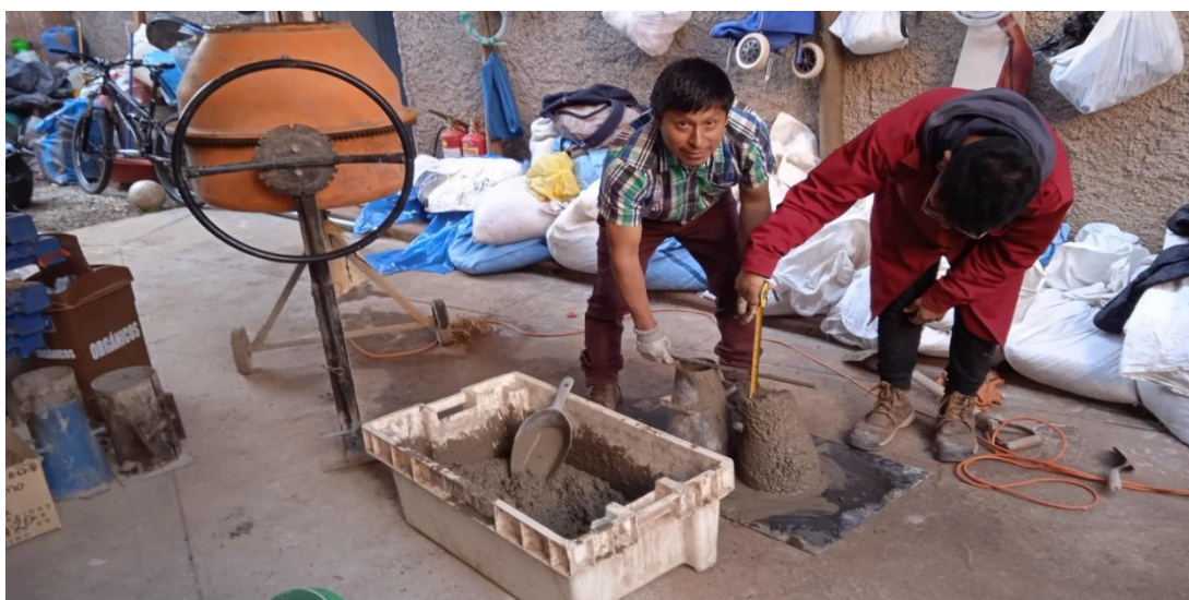
Figura 49. Ensayo sobre la consistencia del concreto.
