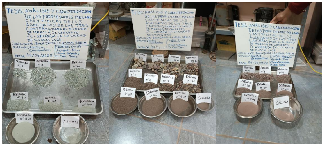
Figura 17. La granulometría del agregado grueso de cada una de las tres canteras Huambutio, Pisac y Zurite.
