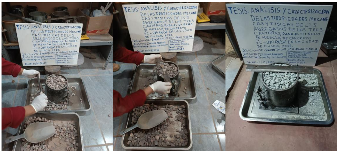
Figura 26. Eliminación del exceso de material grueso de las tres canteras Huambutio, Pisac y Zurite.
