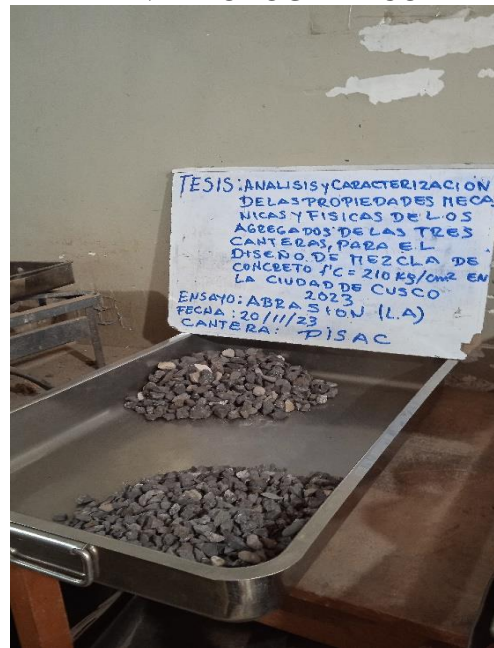
Figura 1. Selección del material para el ensayo de abrasión de la cantera Pisac
