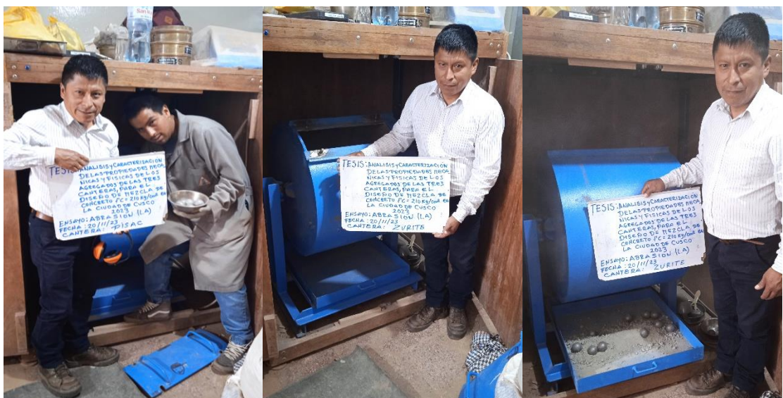
Figura 40. Introducción de la carga y material de ensayo de gradación Tipo B de las tres canteras Huambutio, Pisac y Zurite.
