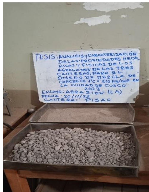
Figura 2. Agregado ensayado en la Maquina de Los Ángeles cantera Pisac.
