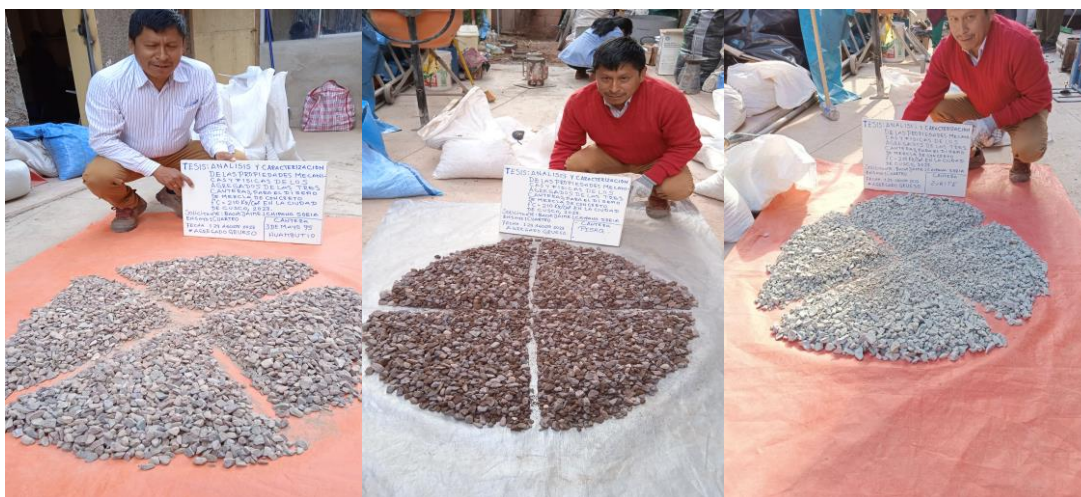
Figura 12. Clasificación de las muestras representativas de agregados gruesos, mediante el método de cuarteo de las tres canteras Huambutio, Pisac y Zurite.
