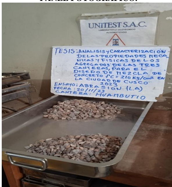
Figura 1. Selección del material para el ensayo de abrasión de la cantera Huambutio (Tres de mayo 95).
