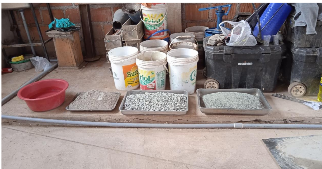
Figura 47. Los materiales o agregados son pesados por lotes, de acuerdo con su diseño de mezcla.
