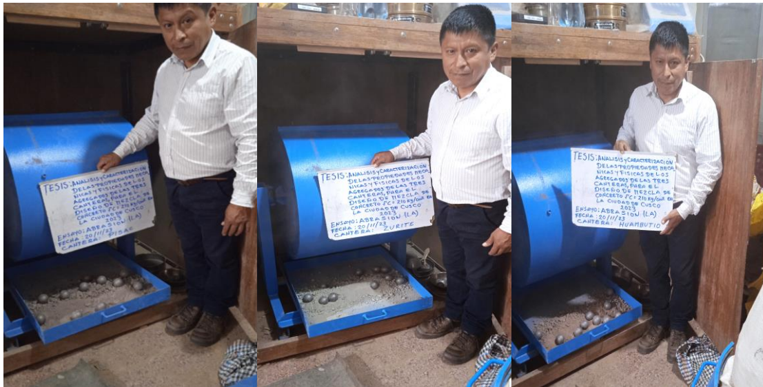
Figura 41. Retiro de la carga y el agregado ensayado de las tres canteras Huambutio, Pisac y Zurite.
