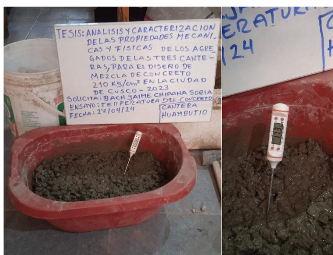
Figura 50. Toma de temperatura a la muestra del concreto fresco.
