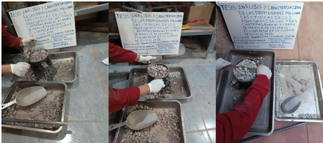
Figura 31. Rellenado, enrasado del material grueso en el molde de las tres canteras Huambutio Pisac y Zurite.
