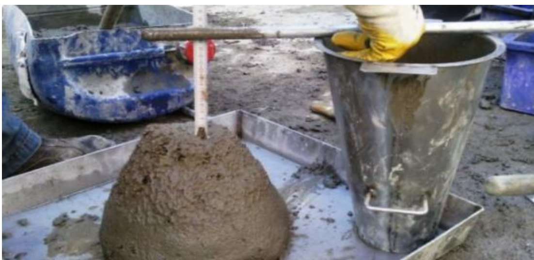
Figura 3. Experimento del cono de Abrams para medir la consistencia.
