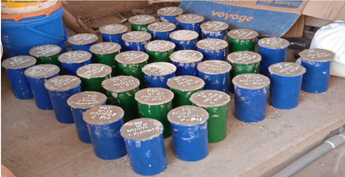
Figura 55. Codificación de las briquetas del concreto, el código de identificación de cada testigo se realiza con probeta N°, la fecha del día de vaciado y la cantera.
