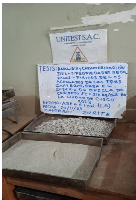
Figura 2. Agregado ensayado en la Maquina de Los Ángeles cantera Zurite.
