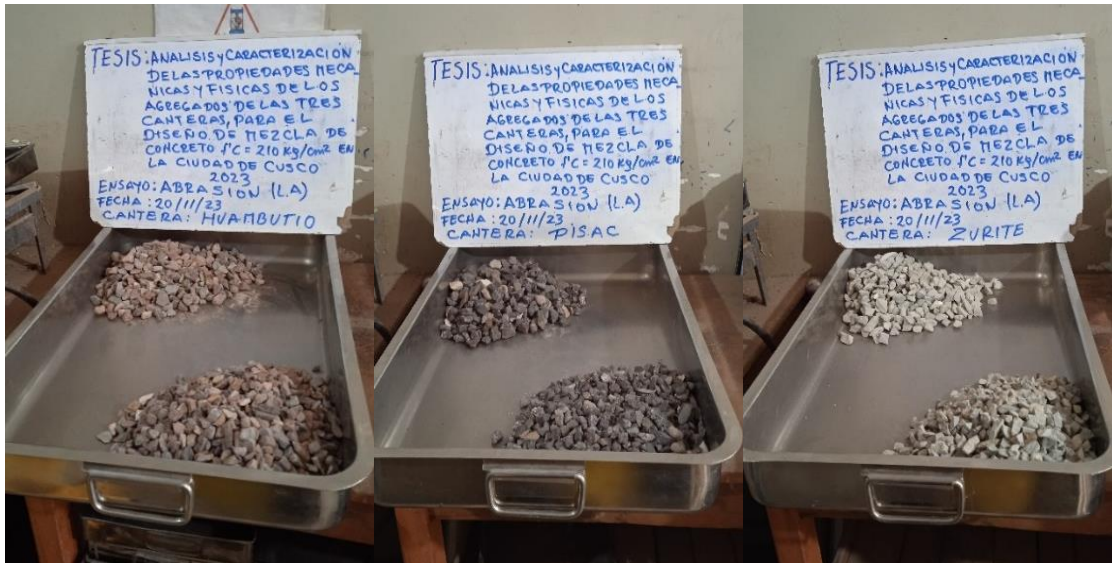
Figura 39. Material o muestra para ensayo separados con serie Tipo B.
