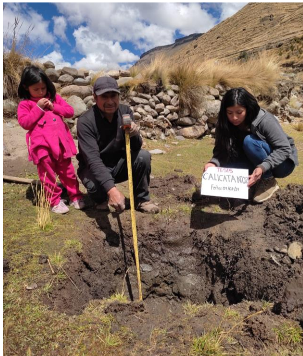
Figura 48: Excavación de calicata N°02 para la extracción de muestras
