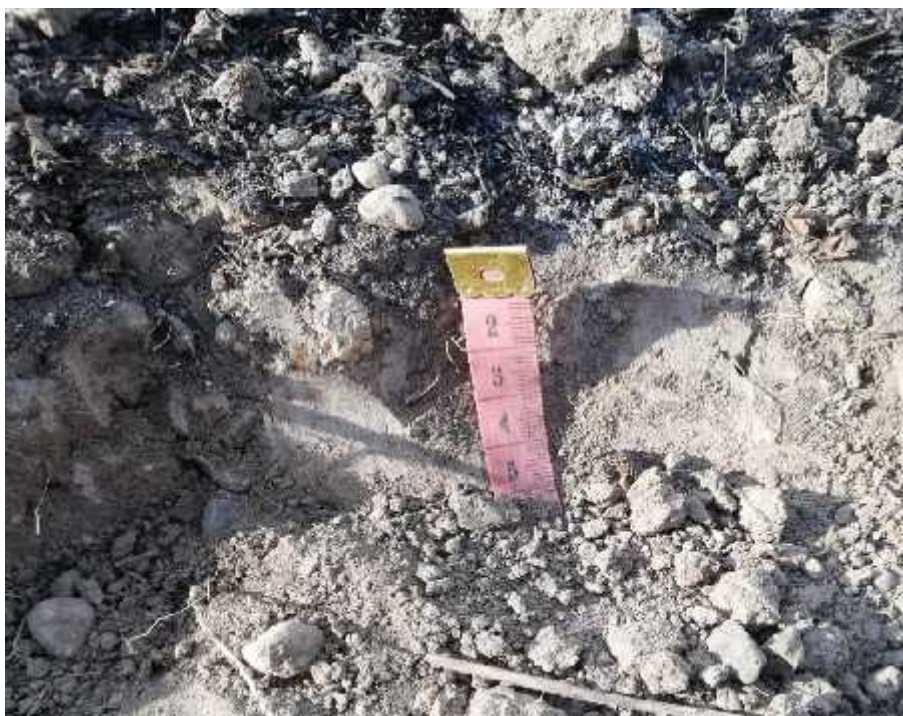
Fotografía 19. Muestreo de suelo quemado según profundidad (3 - 5 cm), predio Túpac Amaru - Huamancaca Chico, Huancayo.
