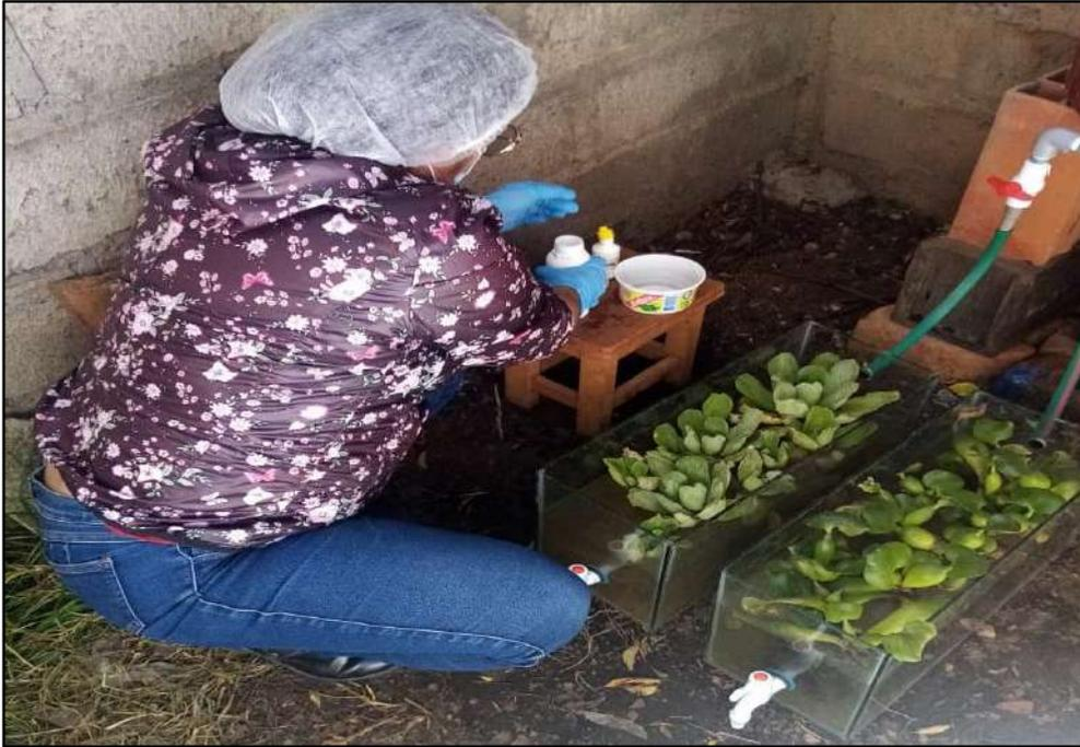
**Toma de muestra de la DQO y aplicación de ácido sulfúrico de la segunda semana**
