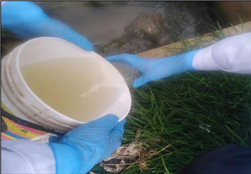
**Toma de muestra para coliformes termotolerantes en el primer punto**
