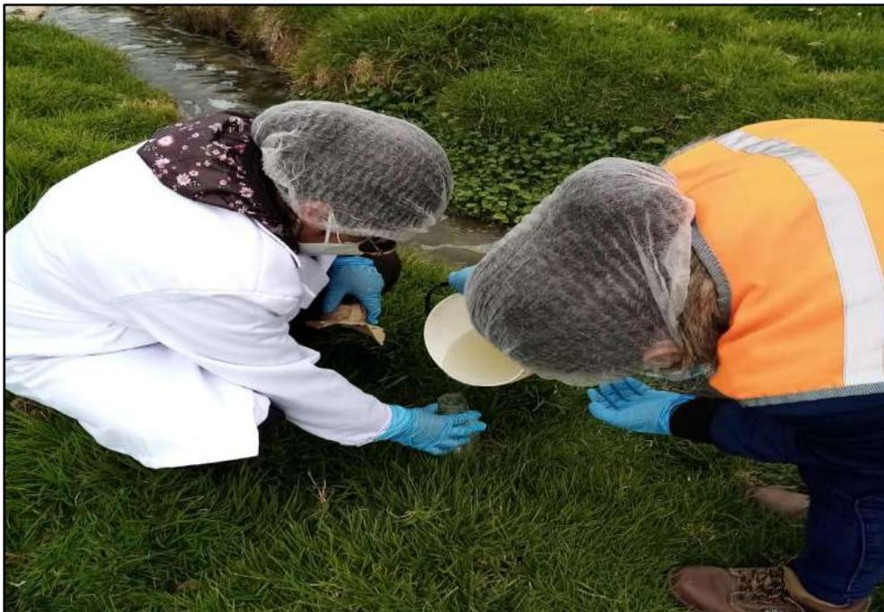
**Toma de muestra para coliformes termotolerantes en el segundo punto**
