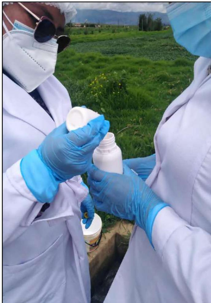
**Aplicación del ácido sulfúrico para la muestra de la DQO**
