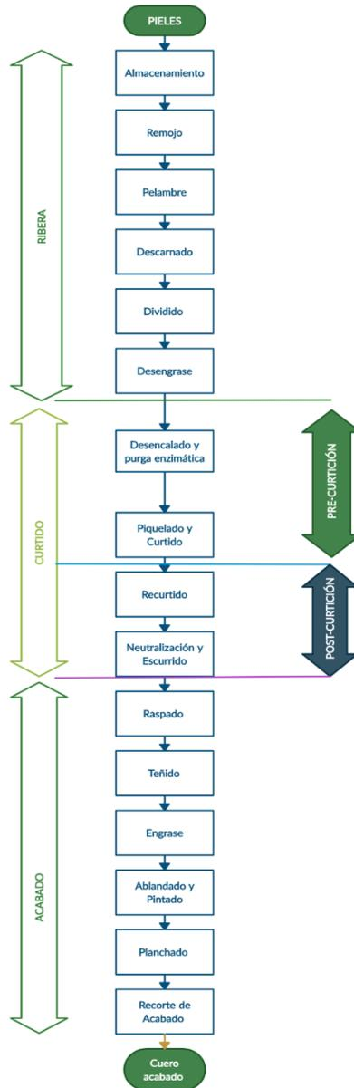
**Figura 5. Flujograma del proceso de producción de cueros.**
