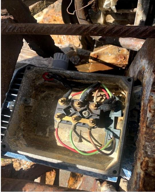
***Motor dañado por demasiada humedad***
