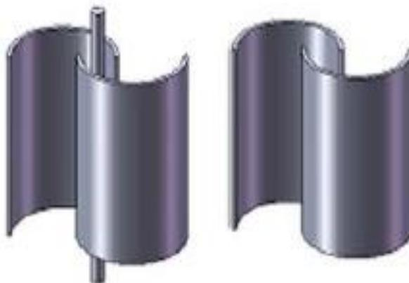
**Figura 27. Rotor Savonius con eje y sin eje (13)**
