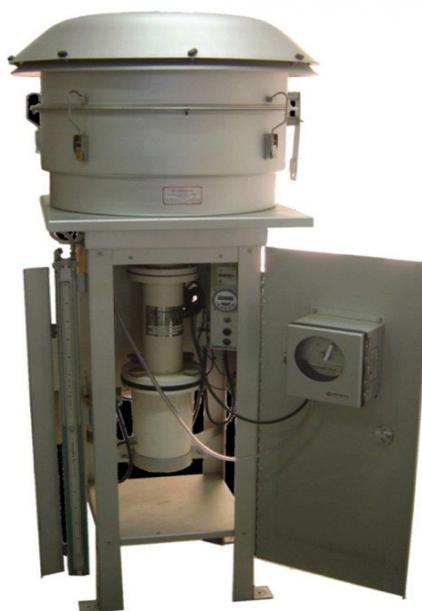
*Figura 4.* Muestreador de alto volumen (Hi vol). Tomado de Instrumentos Básicos para la Fiscalización Ambiental. 2015
