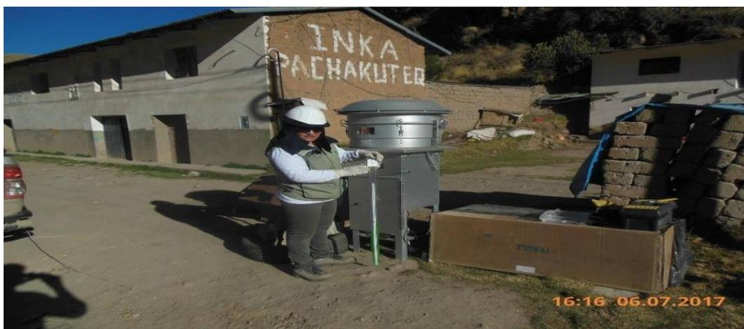
*Figura 18. Utilización de Hivol para la medición de material particulado pm<sub>10</sub>. Tomado de EBM Consultora Empresarial y Ambiental E.I.R.L. año 2017.*
