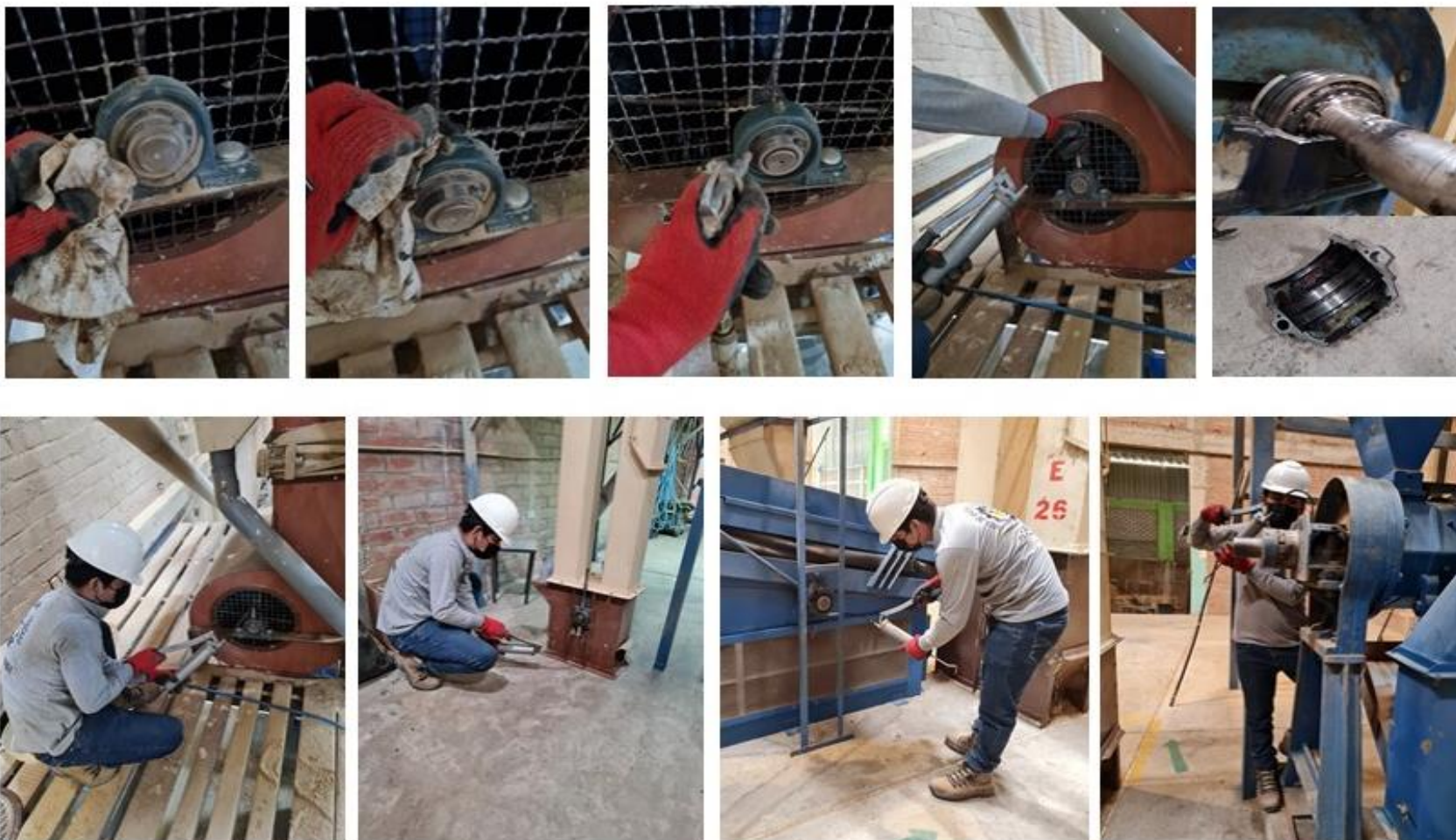
Anexo 13. Lubricación de los rodamientos de la maquinaria en el área de producción.
