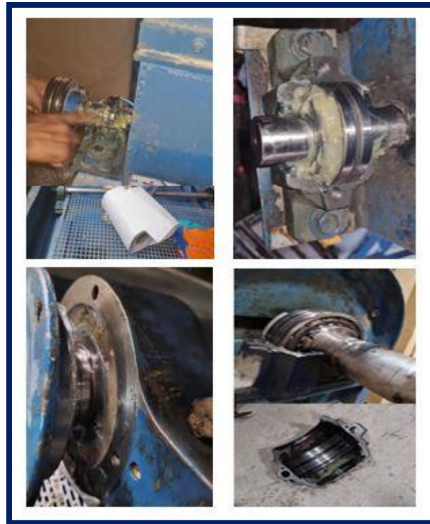
Figura 39. Tareas realizadas para lubricación de rodamiento sin dispositivo de engrase.
