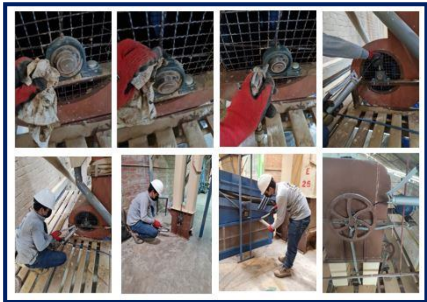
Figura 38. Tareas a realizar para la lubricación de rodamientos con dispositivo de engrase.
