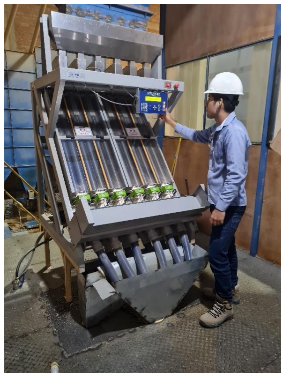
Anexo 15. Programación de las máquinas electrónicas Delta y Xeltron 6-XR para la clasificación de café oro.
