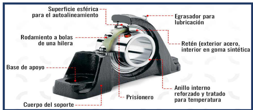
Figura 15. Partes de una chumacera.
