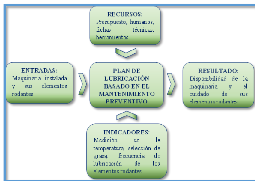
Figura 9. Plan de lubricación basado en el mantenimiento preventivo de los elementos rodantes.
