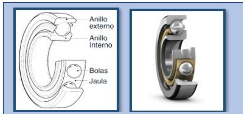
Figura 17. Rodamiento de bolas de contacto angular.
