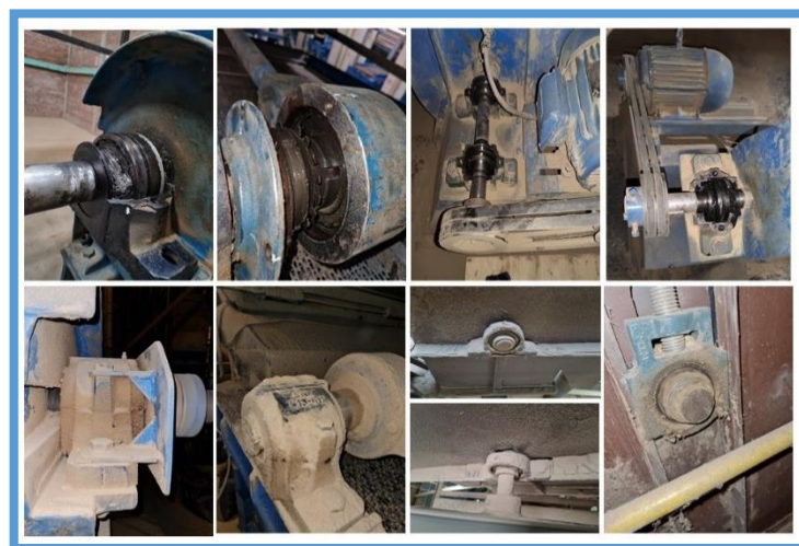
Figura 8. Condiciones de operación con partículas de polvo y desgaste de la grasa en los rodamientos.
