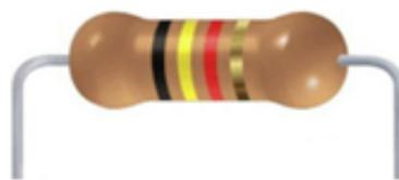
Figura 01: Resistencia típica mostrando su código de colores
