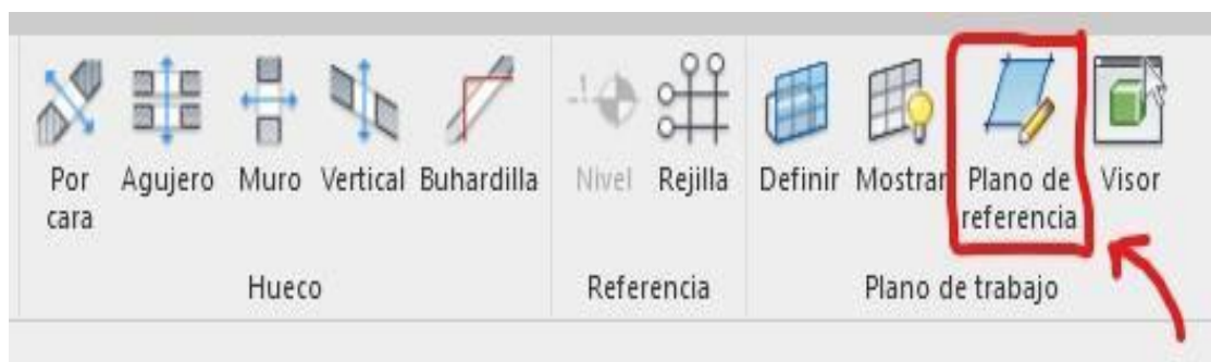
Figura 2. Creación de planos y parametrización (longitud) en Autodesk Revit
