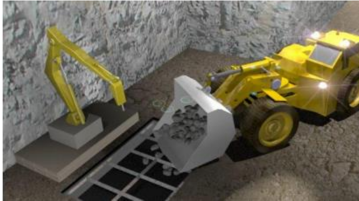
Figura 5. Configuración LHD-punto de vaciado (4 pág. 105)
