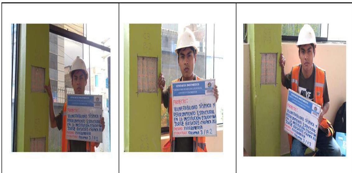
Ensayo de esclerometría -columna 3 (ASTM C -805)
