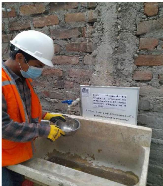
Figura 44. Ensayo de límites de Atterberg (saturación de la muestra 1).
