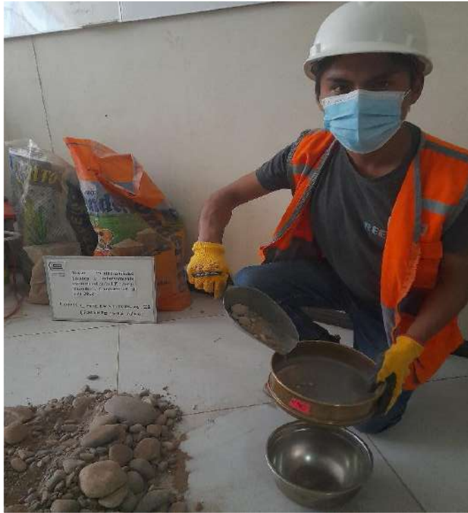
Figura 43. Ensayo de límites de Atterberg (preparación de la muestra 1).
