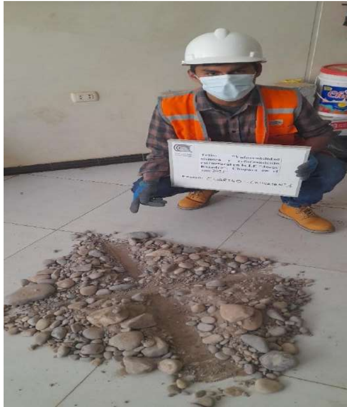
Figura 37. Cuarteo manual de la Calicata 1.
