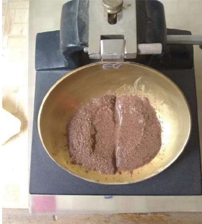
Figura 45. Ensayo de limite liquido (copa de Casagrande - 12 golpes - muestra 1).
