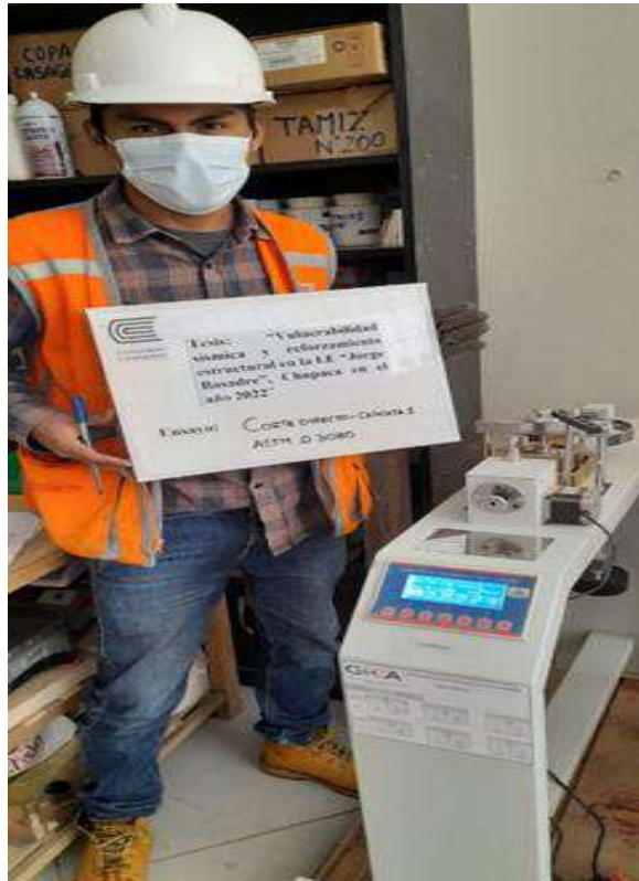
Figura 54. Ensayo de corte directo - Calicata 1.
