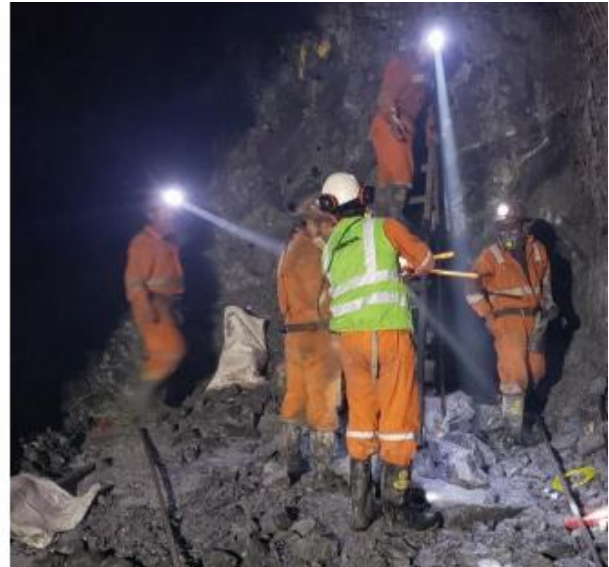
Figura 31. Carguío de frente con Famecorte E-20CX 1169
