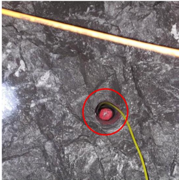
Figura 12. Cartuchos sobrantes son cargados en los taladros sin atacar
