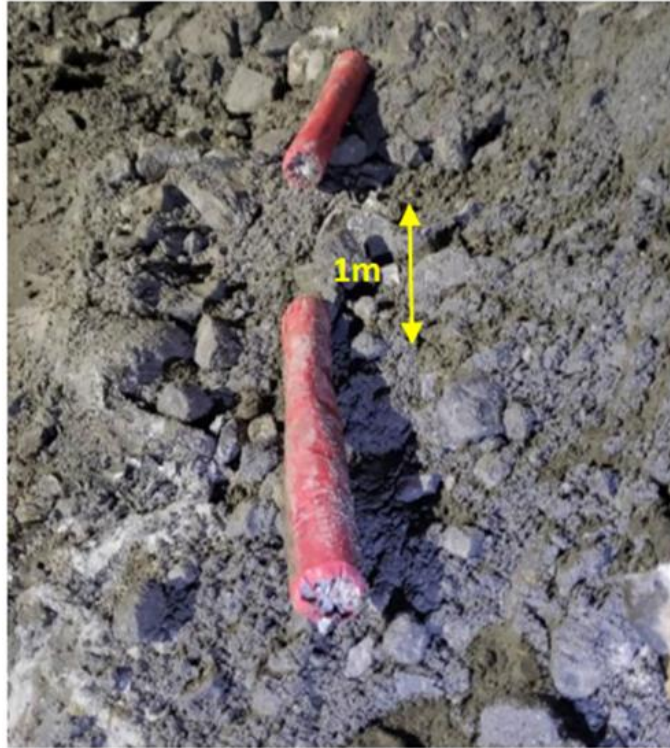
Figura 13. Cartuchos no detonados por no ser atacados en el taladro
