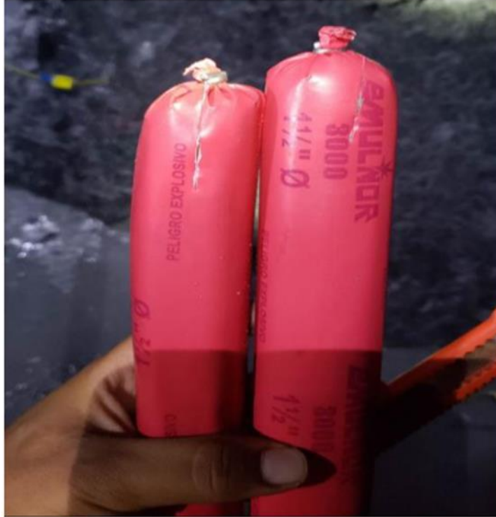
Figura 19. Carguío de frente sin cortar las grapas SN 6917
