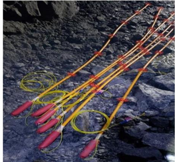
Figura 27. Famecorte E-20 armado SN 6917
