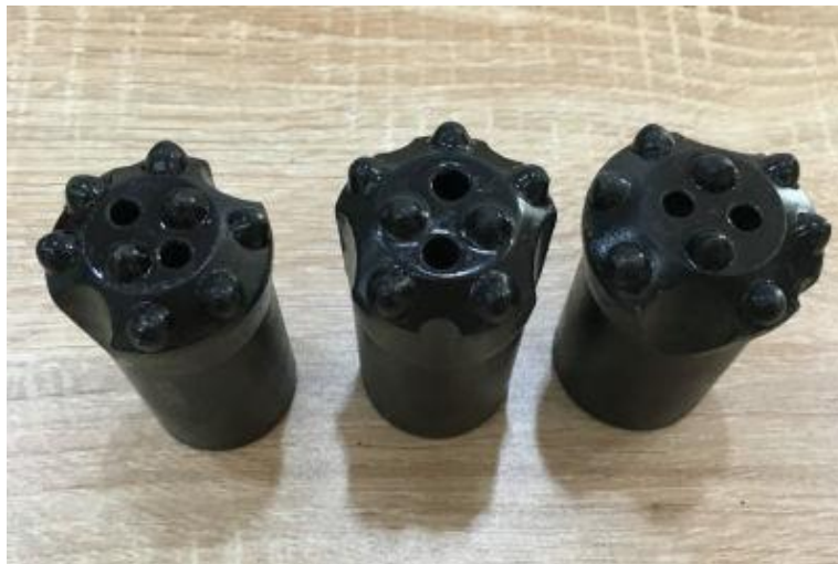
Figura 13. Brocas de perforación (36 mm)
