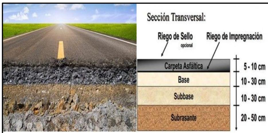
Figura 7. Estructura del pavimento flexible -Capas conformantes.
