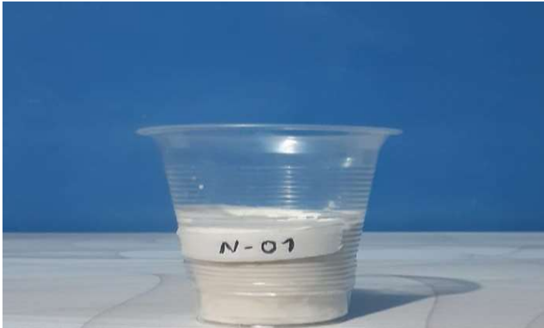
Figura 19. Saponificación completa de la prueba N-01
