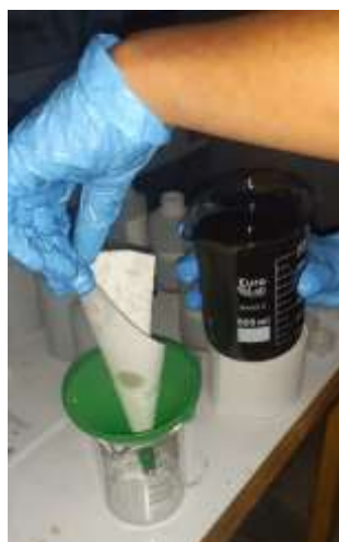
Figura 6. Proceso de filtrado del aceite vegetal reciclado
