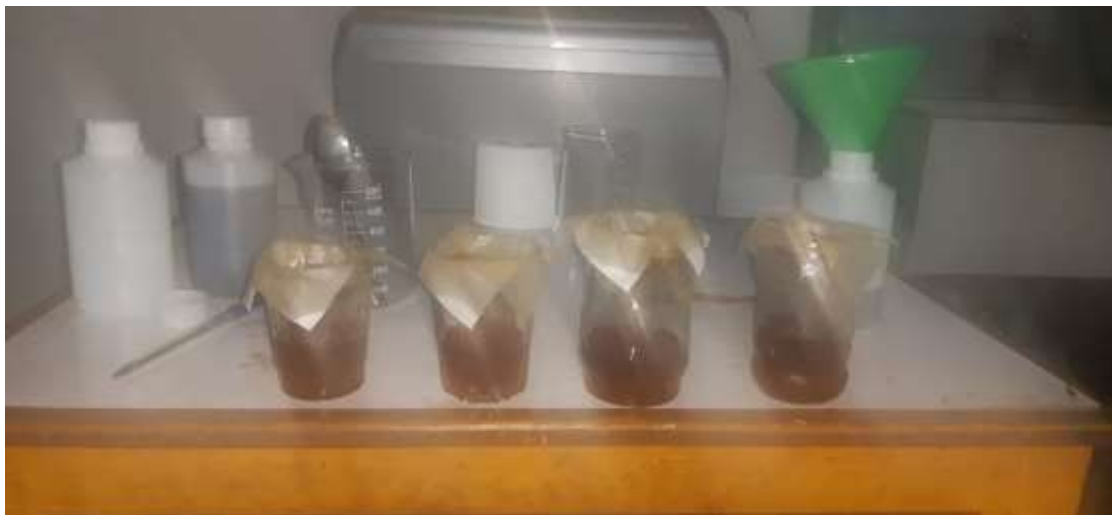
Figura 18. Filtración del aceite vegetal reciclado
