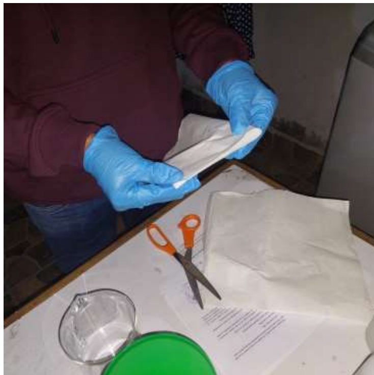
Figura 14. Corte del papel filtro para hacer el proceso de filtración
