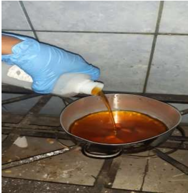
Figura 13. Proceso de calentamiento al aceite vegetal reciclado para su filtración
