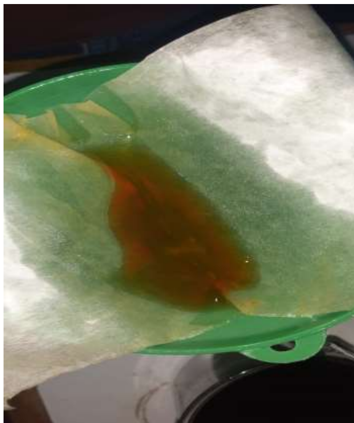
Figura 16. Captación de impurezas del aceite vegetal reciclado durante el proceso de filtración
