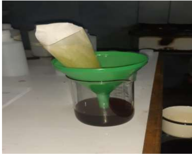
Figura 17. Filtración del aceite vegetal reciclado
