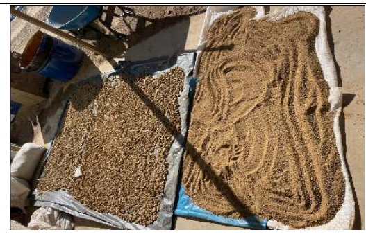
Foto 15. Procedimiento para preparación de suelo grueso de fino
