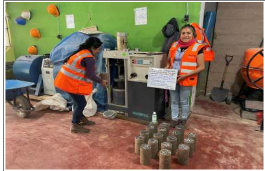
Foto 26. Ejecucion de ensayo de compresion simple de probetas de suelo-cemento
