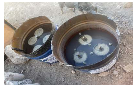
Foto 30. Saturacion de moldes de CBR moldeados con suelo cemento mas aditivo
