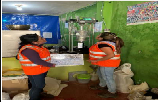
Foto 33. Penetracion de CBR en una maquina manual con lector digital
