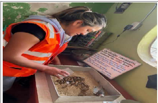
Foto 19. Humedecimiento y homogenización de la mezcla suelo cemento para el respectivo molde
