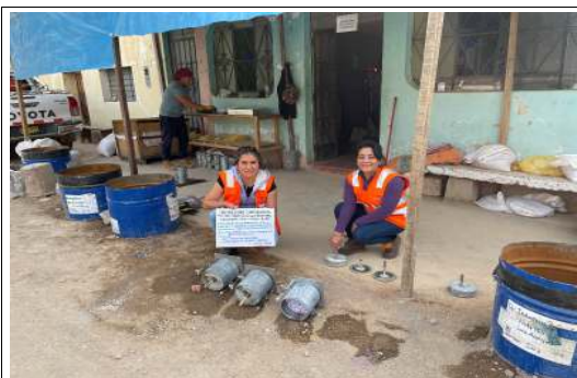
Foto 31. Escorrido de probetas de CBR para la posterior penetracion
