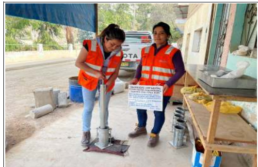
Foto 20. Moldeo de suelo cemento
