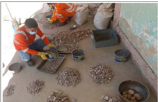
Foto 07. Ensayo de granulometría
