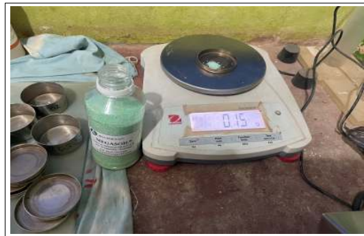
Foto 28. Pesado del polimero Megasoil para el uso en las probetas de suelo cemento mas aditivo
