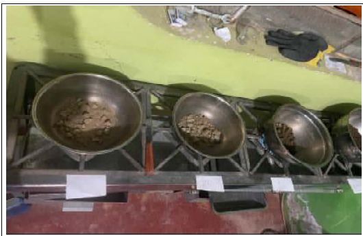
Foto 05. Ensayo de determinación de humedad natural en cocina
