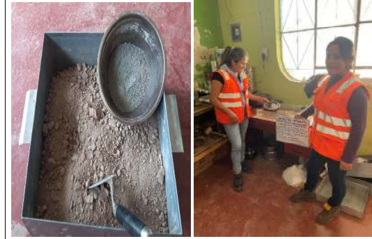
Foto 18. Preparación de suelo para diseño suelo cemento
