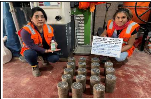
Foto 29. Probetas post-curado para la compresi3n simple de probetas suelo cemento mas aditivo
