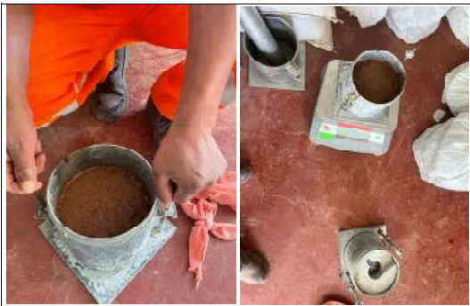
Foto 29. Moldeo de CBR y posterior pesado para la determinacion de la densidad
