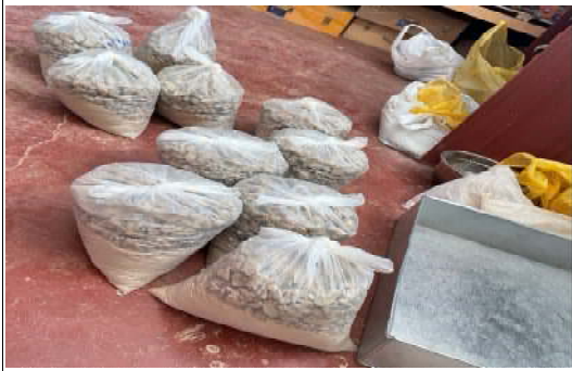
Foto 17. Preparación de suelo para muestreo suelo cemento
