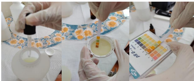
Figura 51. Procedimiento de la preservación de las muestras con \text{HNO}_3
