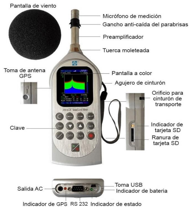
Figura 6. Partes del sonómetro - Clase 1
