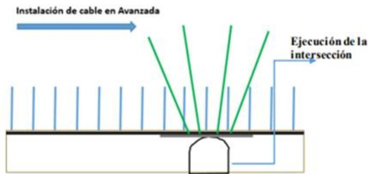
**Figura 24. Instalación e inyección se realizará en avanzada**
