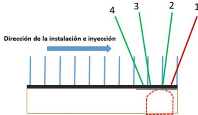
**Figura 18. Instalación e inyección**
