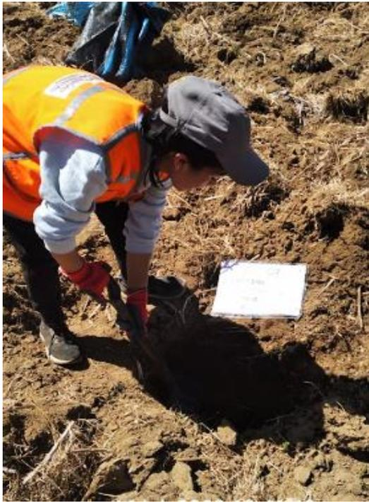
Fotografía 1. Excavación de calicatas para la obtención de muestras.
